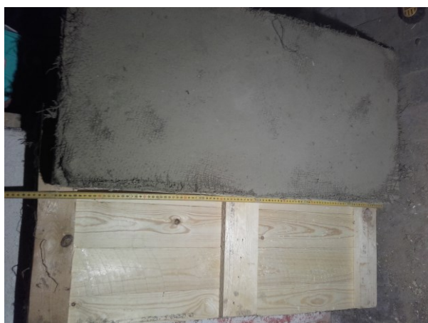
Figur 45: Lerplade med væv på oversiden
