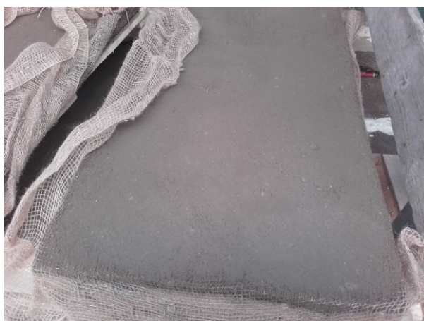
Figur 44: Lerplade med væv på oversiden
