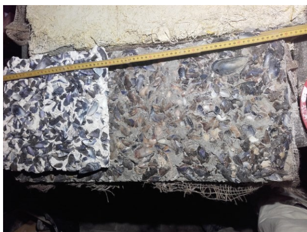
Figur 53: Akustikplade med muslingskaller
