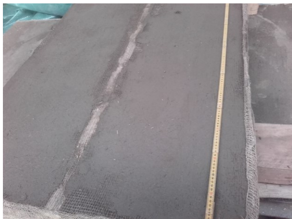
Figur 48: Lerplade med væv på oversiden
