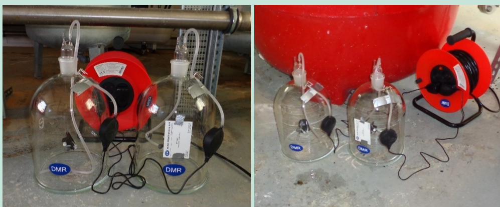
FIGUR 12 FORSØGSOPSTILLING TIL TEST AF TÆTHEDEN AF RETABLERING MED SIKADUR-42 HE OVER SPORGASKILDERNE K3 (VENSTRE) OG K4 (HØJRE). ÉN KLOKKE OVER DET RETABLEREDE HUL (KLOKKE A) OG ÉN OVER ET STYKKE REFERENCEGULV LIGE VED SIDEN AF (KLOKKE B).
