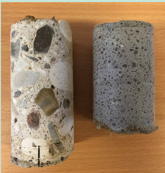
FIGUR 9 BOREKERNER AF HHV. INTAKT BETON FRA SKOVLUNDE BYVEJ 96A OG EN KERNE AF SIKADUR-42 HE.
