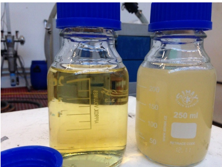
FIGUR 9. PRØVER AF SYREBEHANDLET KØLE-SMØRE-MIDDEL FØR (HØJRE) OG EFTER MEMBRANFILTRERING (VENSTRE)
