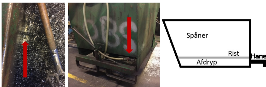
FIGUR 13. SPÅNVOGN MED METALSPÅNER OG KØLE-SMØRE-MIDDEL (VENSTRE), SPÅNVOGN MED AFDRYPNINGSHANE OG SKEMATISK PRÆSENTATION AF SPÅNVOGN SET FRA SIDEN MED RIST TIL AFDRYPNING AF METALSPÅNERNE. DEN RØDE PIL PÅ BILLEDET TIL VENSTRE VISER KØLE-SMØRE-MIDLET, SOM ER DRYPPET AF METALSPÅNERNE, OG DEN RØDE PIL PÅ BILLEDET I MIDTEN VISER AFTAPNINGSHANE PÅ EN SPÅNVOGN.
