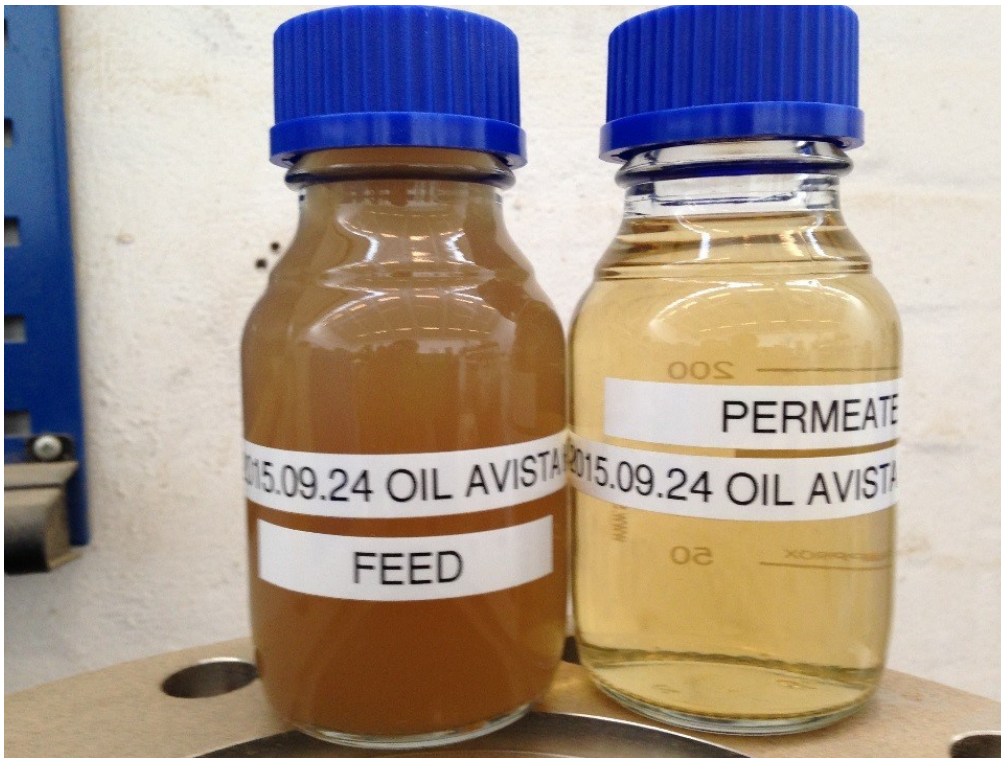
FIGUR 12. BILLEDER AF PRØVER FØR (FEED) OG EFTER MEMBRANFILTRERING (PERMEAT)
