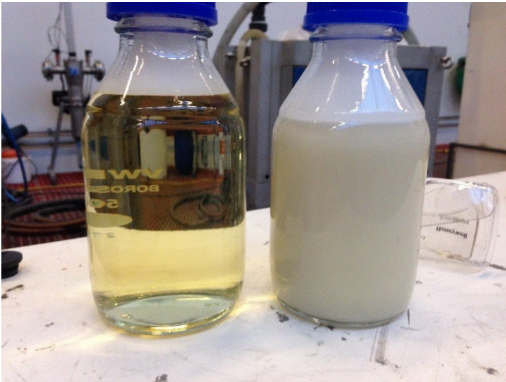
FIGUR 10. PRØVER AF KØLE-SMØRE-MIDDEL, HVOR DE VÆRSTE OLIERESTER ER FJERNET, FØR (HØJRE) OG EFTER MEMBRANFILTRERING (VENSTRE)
