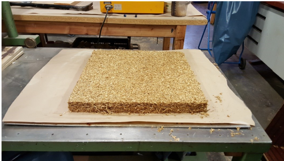
Billede 3.2.1 b: Testproduktion af spånplader
