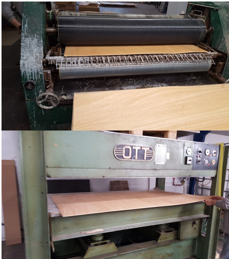
Billede 3.2.1 a: Testproduktion af krydsfinerplader 120x240 cm
