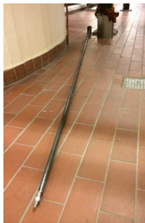
FIGUR 12. 5 METER LANG SLAGGEUDTAGNINGSAGGREGAT
