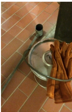
FIGUR 11. PRØVEUDTAGNINGSAGGREGAT TIL UDTAGNING AF SLAGGEPRØVE DIREKTE FRA OVN, SAMT PRØVESPAND OG VARMERESISTENTE HANDBSKER
