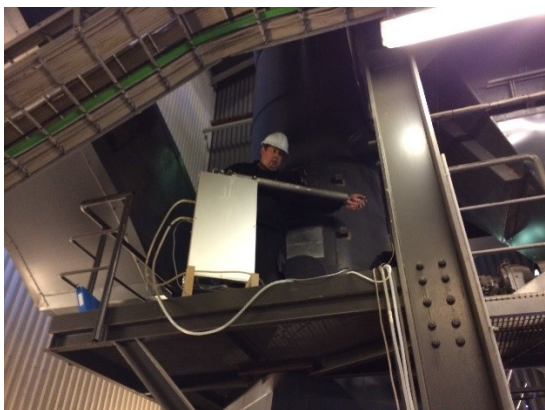
FIGUR 19. UDSTYR TIL OPSAMLING AF MATERIALE TIL PCDD/F OG PAH ANALYSER ER VED AT BLIVE RIGGET TIL AF MEDARBEJDER FRA TEKNOLOGISK INSTITUT
