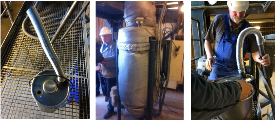
FIGUR 14. PRØVETAGNINGSSPAND TIL E- FILTERUDTAG
