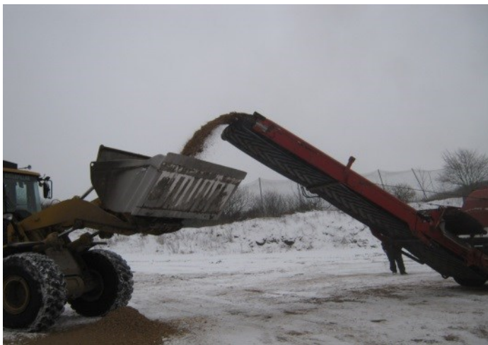
FIGUR 8. UDTAGNING AF SEKUNDÆR DELPRØVE EFTER LEJET SHREDDER
