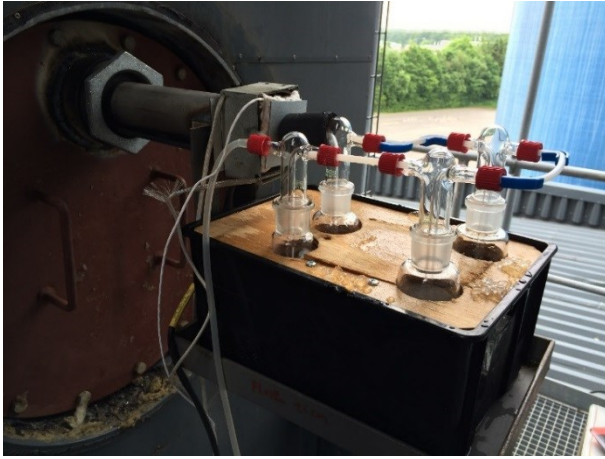
FIGUR 21. PRØVEUDTAGNINGSPUNKT I SES MONTERET MED VASKEFLASKER TIL METALOPSAMLING
