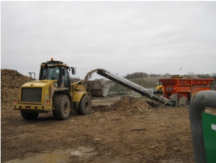
FIGUR 6. UDTAGNING AF PRIMÆR DELPRØVE AF MATERIALESTRØMMEN EFTER SHREDDEREN
