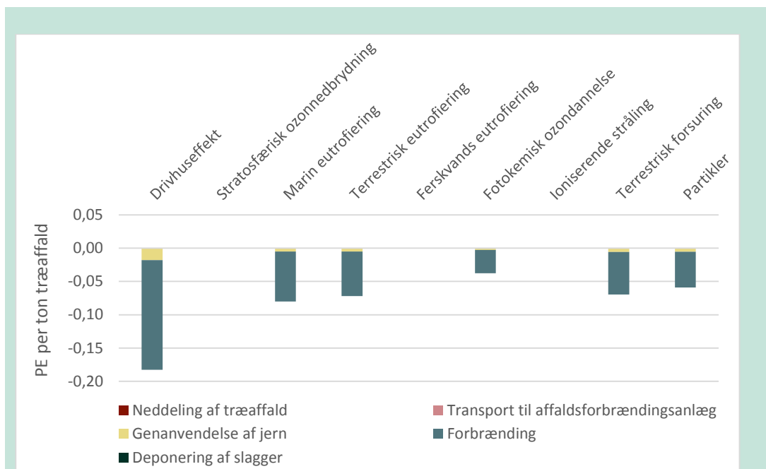
FIGUR 28 POTENTIELLE IKKE-TOKSISKE PÅVIRKNINGER MÅLT I PERSONÆKVIVALENTER (PE) PER TON IMPRÆGNERET TRÆAFFALD FOR SCENARIO 4: DEDIKERET FORBRÆNDING PÅ AFFALDSFORBRÆNDINGSANLÆG
