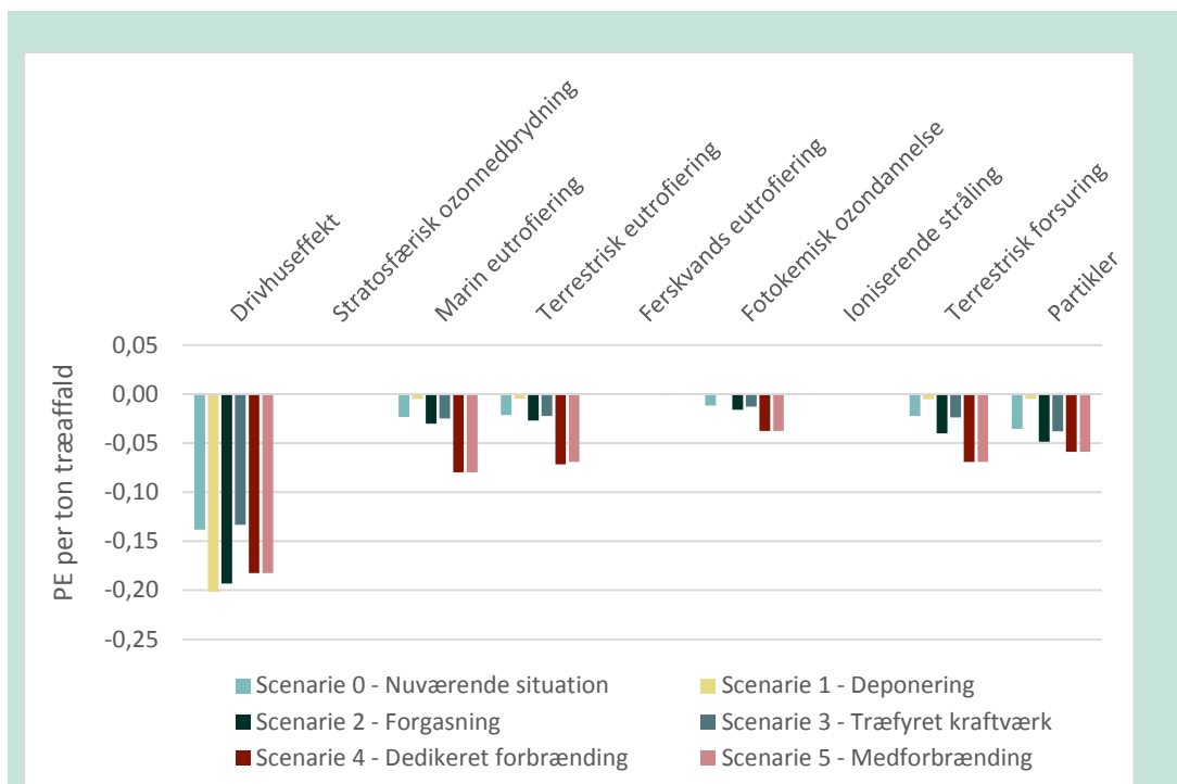
FIGUR 1 SAMLEDE POTENTIELLE IKKE-TOKSISKE MILJØPÅVIRKNINGER MÅLT I PERSONÆKVIVALENTER (PE) PER TON TRÆAFFALD FOR ALLE SCENARIER.
