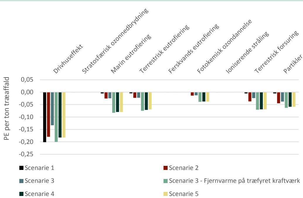
FIGUR 42 SCENARIERNES POTENTIELLE IKKE-TOKSISKE PÅVIRKNINGER MÅLT I PERSONÆKVIVALENTER (PE) PER TON IMPRÆGNERET TRÆAFFALD. FØLSOMHEDSANALYSE: FJERNVARMERPRODUKTION PÅ TRÆFYRET KRAFTVÆRK
