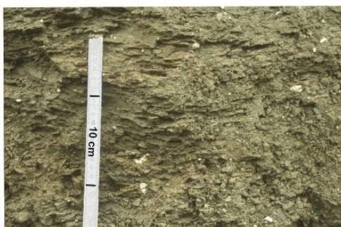
FIGUR 18: BILLEDE AF NATURLIGE FRYSE/TØ-SPRÆKKER FRA MORÆNELERS-PROFILER VED KYSTPROFIL PÅ GEDSER OG UDGRAVNING FRA AMAGER.
