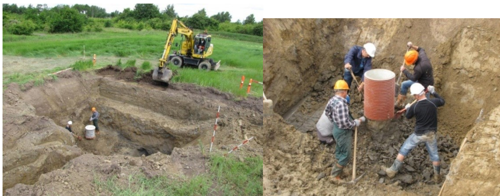
FIGUR 3: TO STORE INTAKTE (LUC) PRØVER OG EN RÆKKE MINDRE INTAKTE "KLODSE" OG RØRPRØVER BLEV UDTAGET PÅ TEKNOLOGISK INSTITUT'S FORSØGSMARK VED HØJE TÅSTRUP.
