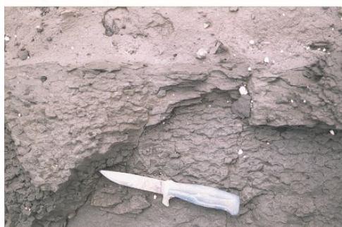
FIGUR 18: BILLEDE AF NATURLIGE FRYSE/TØ-SPRÆKKER FRA MORÆNELERS-PROFILER VED KYSTPROFIL PÅ GEDSER OG UDGRAVNING FRA AMAGER.
