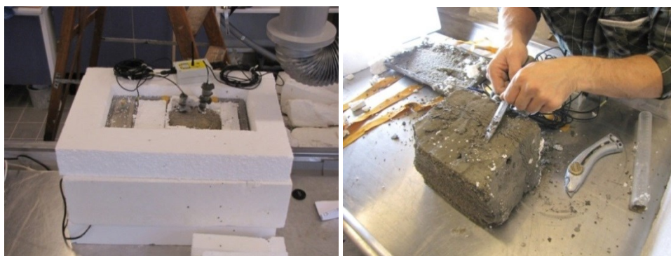
FIGUR 17: BILLEDE AF FORSØGSOPSTILLING MED SOUS VIDE GRYDE OG MONTERET MORÆNELERSPRØVE INDEN FRYSEFORSG (TIL VENSTRE) OG EFTER UDTAGNING AF DELVIS FROSSET SOUS VIDE PRØVE (TIL HØJRE).
