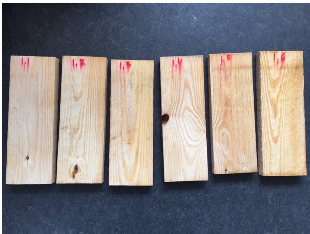
Figur 11: Forsøgsrække 2, træemnerne 1.1-1.6. Træemnerne er imprægneret med en opløsning indeholdende 20 % (w/w) DMDHEU-resin og 6 % (w/w) magnesiumchlorid i henholdsvis 4 timer (1.1 & 1.2), 8 timer (1.3 & 1.4) og 24 timer (1.5 & 1.6). Der ses en let øget farveændring med øget hærkningstid, men selv for træemnerne 1.5 og 1.6, der er hærdet i 24 timer, er farveændringen ret beskedent sammenlignet med træemnerne fra forsøgsrække 1, der ses i Figur 10.
