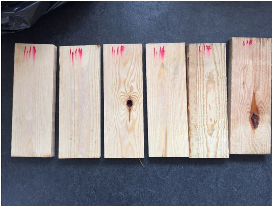
Figur 13: Forsøgsrække 2, træmnerne 1.13-1.18. Træmnerne er imprægneret med en opløsning indeholdende 20 % (w/w) DMDHEU-resin, 3 % (w/w) citronsyre og 1 % (w/w) magnesiumchlorid i henholdsvis 4 timer (1.13 & 1.14), 8 timer (1.15 & 1.16) og 24 timer (1.17 & 1.18). Der ses en let øget farveændring med øget hærkningstid, men selv for træmnerne 1.17 og 1.18, der er hærdet i 24 timer, er farveændringen ret beskeden sammenlignet med træmnerne fra forsøgsrække 1, der ses i Figur 10. Ved sammenligning med Figur 12 fremgår det, at farveændringen er lidt mindre udtalt for træmnerne behandlet med opløsning indeholdende citronsyre.
