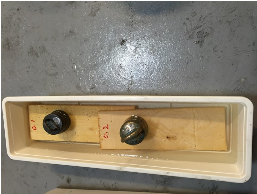
Figur 5: Billede af "imprægneringskar" med to træemner. Karret benyttes for at spare på imprægneringsvæsken. Herved undgås, at hele imprægneringstanken skal fyldes op med væske. Træemnerne holdes nede i væsken ved hjælp af to lodder.
