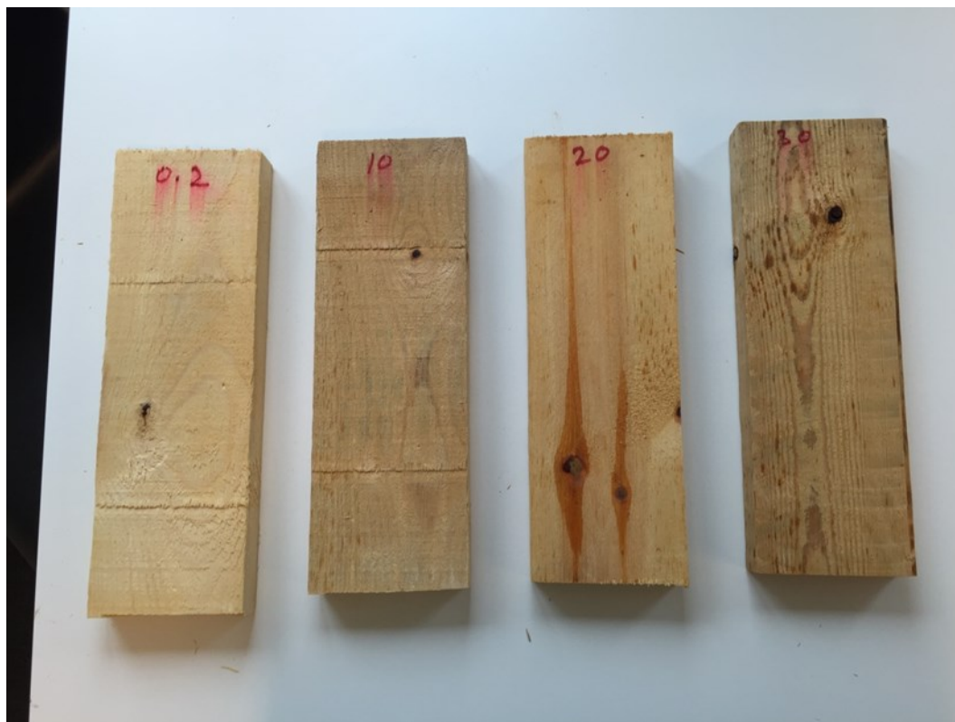
Figur 10: Illustration af katalysatorernes indvirkning på træets farve. Træemne 0.2: 0-prøve (uden katalysator); træemne 10: 7,5 % (w/w) magnesiumchlorid; træemne 20: 7,5 % (w/w) citronsyre; træemne 30: 1 % (w/w) magnesiumchlorid og 3 % (w/w) citronsyre. Indvirkningen af især magnesiumchlorid ses tydeligt ved sammenligning med 0-prøven.
