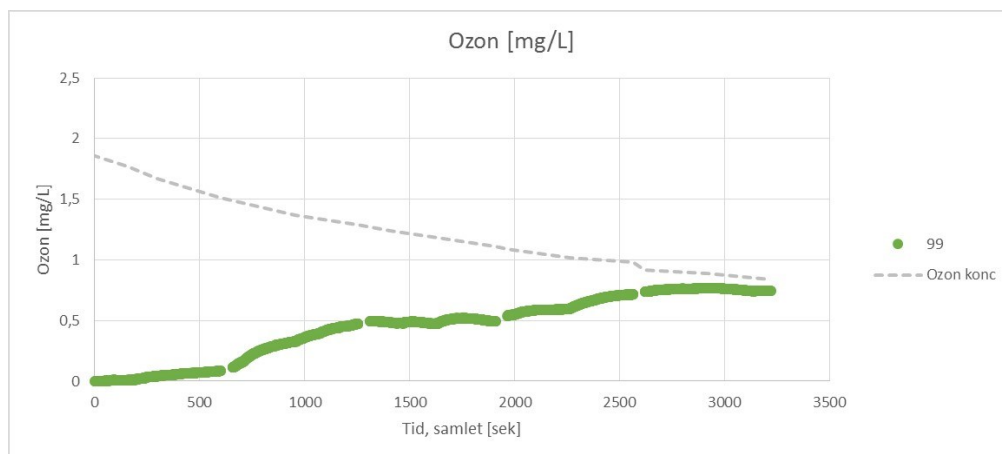
Figur 15: Ozonmålinger udført ved 2°C. Her vist uden membran (99) sammen med den aflæste ozonkoncentration i vandet. Som forventet er der en respons fra ozon.
