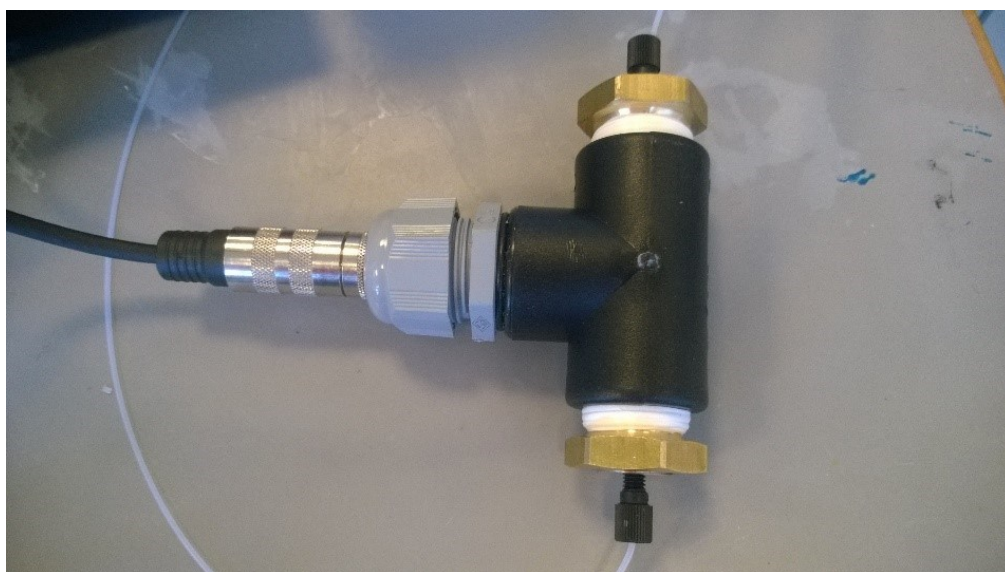
Figur 12: Kombineret fugt- og temperatursensor monteret i sensorhuset.
