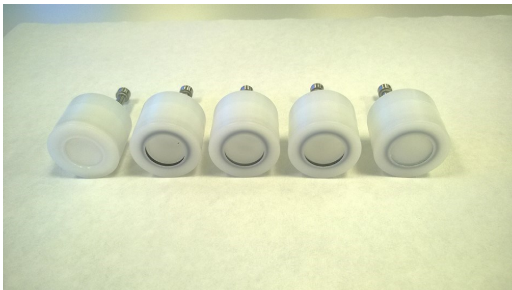
Figur 11: Række af flowceller med de testede membraner.
