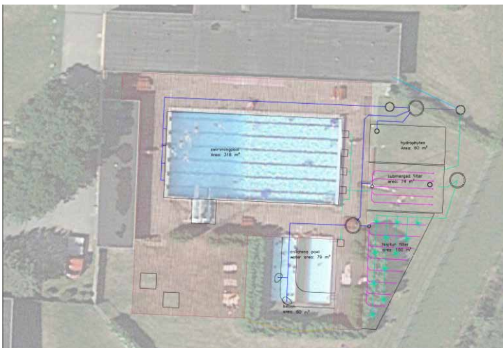
Figur 11.6: Oversigt over bassiner og biologisk rensanlæg ved RVF. Ved sammenligning med flowdiagram i figur 8 ses at tegningen ikke er helt præcis, men figuren viser tydeligt de lilla drænslanger under de to substratfiltre, Filter 1 og Filter 2.
