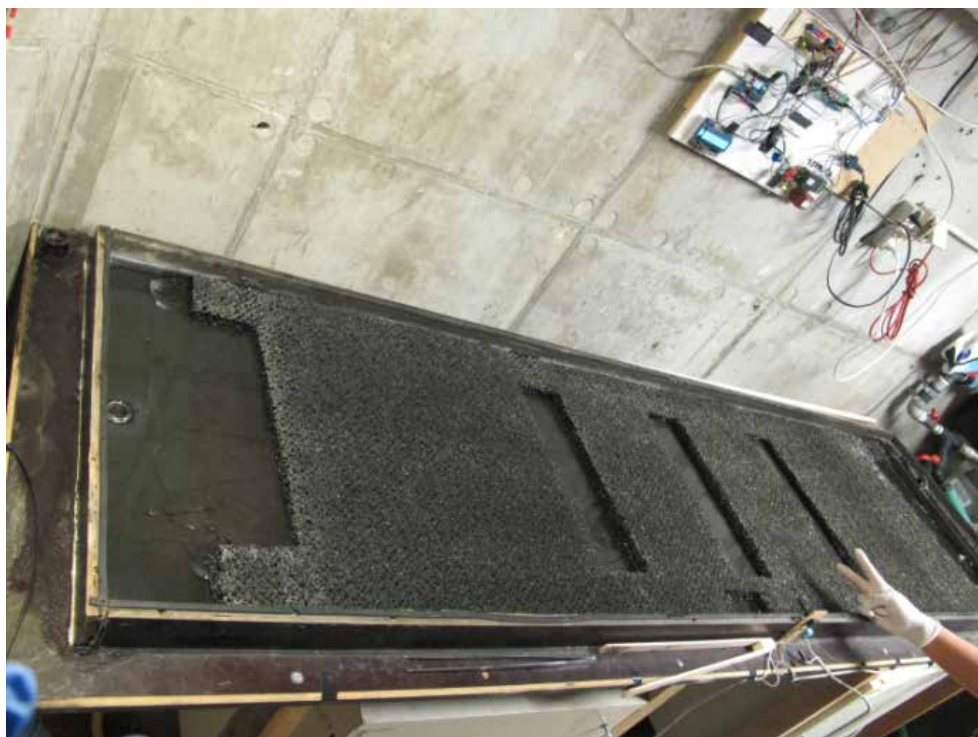
Figur 7.4: Foto af pilotopstilling under forberedelse af net til udtagning af delprøver af net i forskellig afstand fra indløbet og til forskellige tidspunkter.
