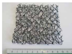
Figur 7.3: Som medie for biofilmens fasthæftning blev benyttet et polyamid-net af mærket Enkamat, som vist på fotoet.
