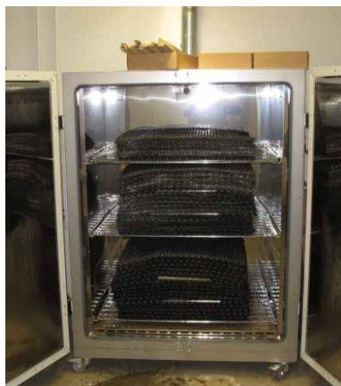
Figur 7.47: Efter afdræning og fotografering af de enkelte lag, blev alle lagene tørret i oven for bestemmelse af akkumuleret tørstof (Figur 7.46).
