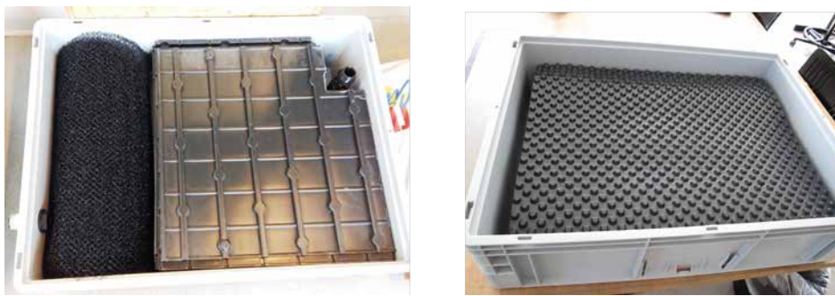
Figur 7.12: Til venstre ses foto af Boks 1 klar til indbygning i DPF-Gråvandstårnet. Boks 1 er indrettet anderledes end de øvrige bokse, da denne boks fungerer som modtageboks, og derfor vil være ekstra udsat for tilstopning med hår og større partikler. Den sammenrullede Enkammat fungerer som forfilter, mens de efterfølgende plader fungerer som sedimentfang. Til højre ses en af de øvrige syv bokse under indbygning af renselag. Øverste synlige plade er en Icopal-plade, hvor hulrummene vender opad, beregnet til forsyning af underliggende biofilm med ilt.
