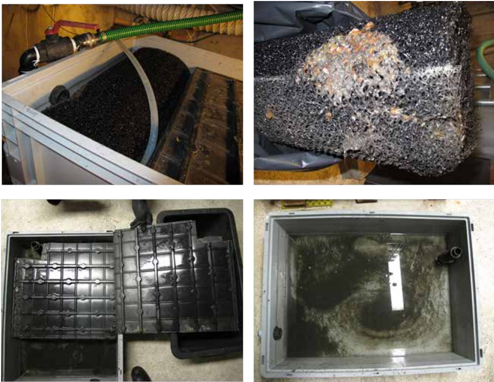
Figur 7.48: Fotos af specialbyggede Boks 1 (forfilter) efter forsøg. Øverst: hårfilter i form af enkamat-rulle og øverste sedimentfangstplade. Den hvide slange hører til ISCO-sampleren. Zoom på område med biofilm. Nederst: Underside af plade 2 og overside af plade tre, samt tom boks med restvand og sediment.
