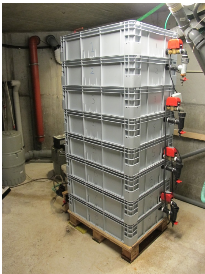
Figur 7.10: DPF-Gråvandstårn, benyttet ved fuldskalaforsøg, bestående af otte bokse, med grundareal ca. 0,5 m 2 og samlet højde 1,8 m. Gråvand tilførtes fra gråvandstank til øverste boks, Boks 1, via et indløb i venstre side (ikke synligt på foto), og vandet løb herefter fra boks til boks portionsvis ned i gennem tårnet. Fyldning og dræning af hver boks blev styret ved hjælp af timerkontrolleret ventil (rød firkant) placeret på udløbsrøret fra hver boks. Ved hjælp af aftapningshaner (lodret studs med lille rød ventil) kunne der udtages prøver af indløbsvandet, influent (Prøve 1) samt af udløbsvandet, effluent, fra alle bokse (Prøve 2 – 9). Der blev også benyttet fraktionsopsamler (ISCO, ses som grå tøndeformet beholder bagerst til venstre i billedet) til automatisk prøvetagning af influent (indløb til Boks 1) og effluent fra tårnet, dvs. udløb fra Boks 8 (Prøve 9).
