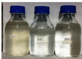
Figur 7.23: Visuel dokumentation for ændring i vandets klarhed efterhånden som DPF-Gråvandstårnet passeres. Øverst: Serie med prøver udtaget samtidig fra alle prøvetagningssteder 1-9 en dag i opstartsfasen; yderst til venstre ses influentprøven, herefter effluent fra Boks 1, 2, 3, 4, 5, 6, 7 og 8. Nederst: Serie med prøver af influent (5.1) samt effluent fra Boks 4 (5.5) og Boks 8 (5.9) udtaget samtidig i den sidste uge af hovedforsøget.
