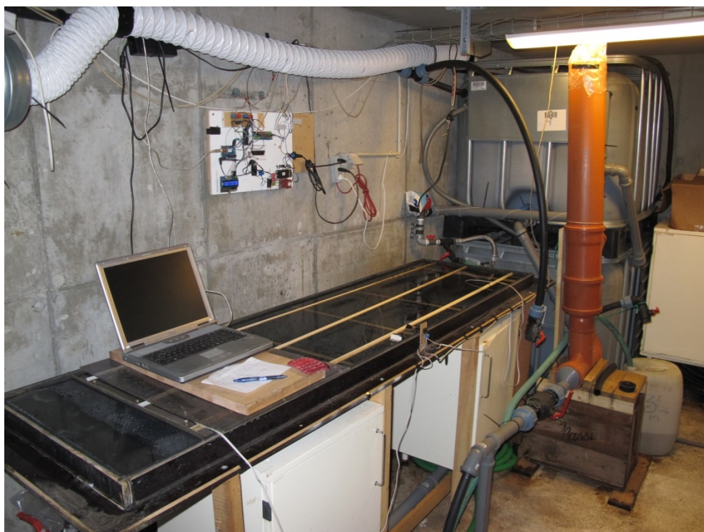
Figur 7.2: Foto af opstilling til pilotforsøg. Gråvands-pallettanke ses bagerst. Det orange rør er forfilter. Reaktoren er den sorte flade kasse. Billedet er taget under forberedelse af forsøgene.
