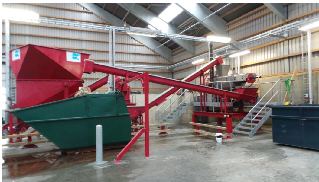
Billede 3: Rejekt ledes via påslag til container (tv) og biopulp pumpes til container (th.)
