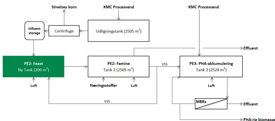
**FIGUR 10: Konceptuel proces flow diagram for produktion af PHA-rig biomasse hos KMC i fuldskala.**
