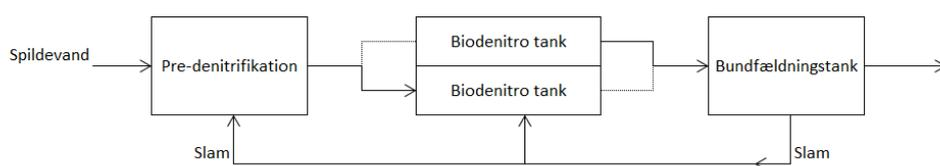
**FIGUR 15: Eksempel på introduktion af en pre-denitrifikation, hvor biomassen oplever fast-betingelser (PE2-fest).**
