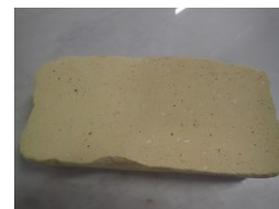
Billede 2: Planslibning af gul blødstrøgen mursten til stenportrætter
