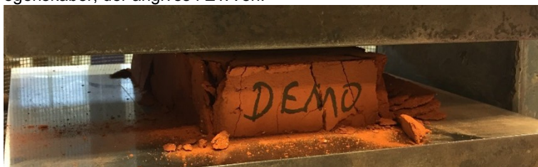
Billede 4: Test af trykprøvning af mursten
