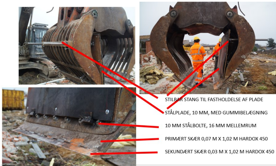
Figur 4.2. Modificeret sorteringsgrab til skånsom nedrivning af murværk.
