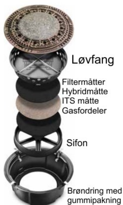
Figur 1. Opbygning af et brøndkarmsfilter (modificeret fra Fritzmeier Umwelttechnik, 2018)
