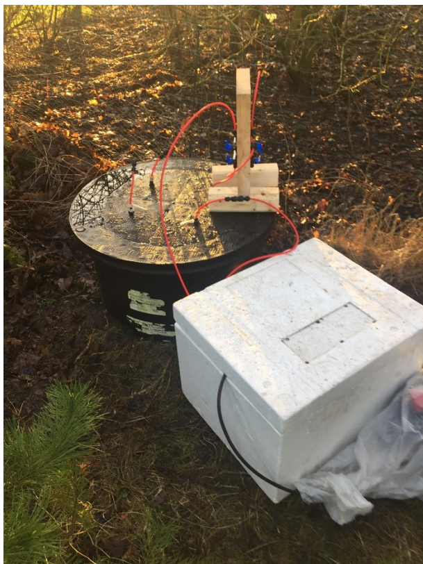
Figur 10. Brønddæksel med gennemføringer og slanger til prøvetagning i luft og spildevand.
