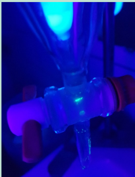
FIGUR 23. Fluorescerende mikroplast, som sidder fast i densitetsseparationen - også efter skylning.
