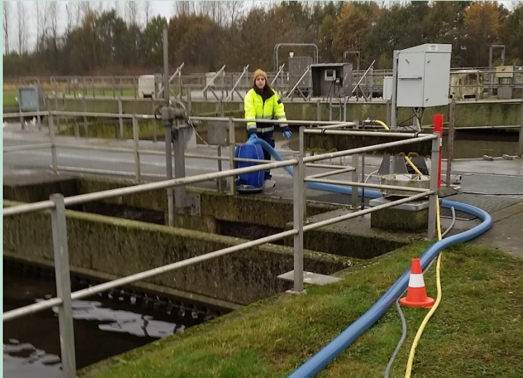
FIGUR 20. Opsamling af mikroplast kugler efter båndfilteret.
