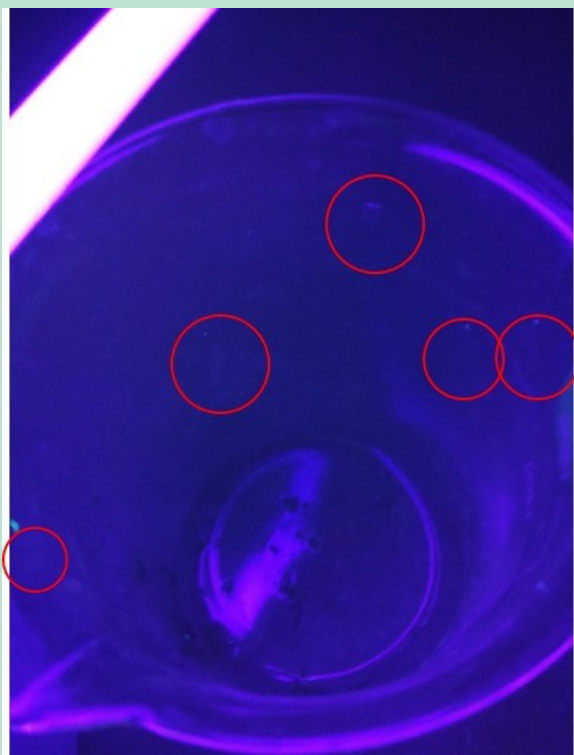
FIGUR 12. Mikroplastkugler tilbage i glasset efter omhældning til båndfilter, forsøg 2.
