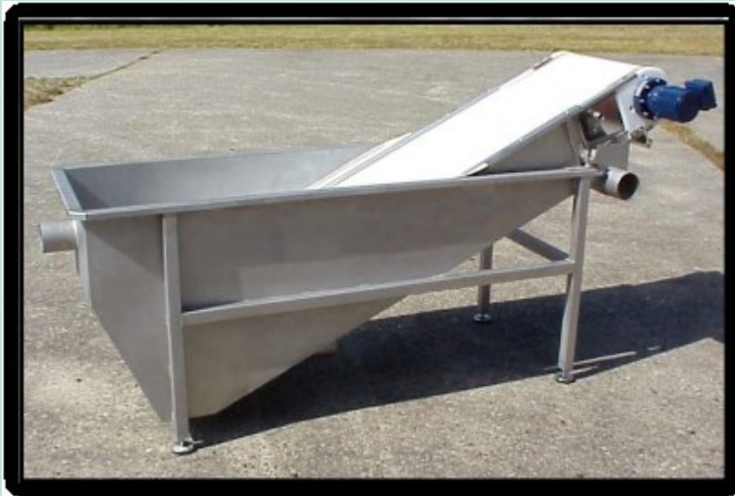
FIGUR 4. AL-2-båndfilter placeret i kar. Øverst: trækvalse med motor og spuleanordning med afløb på underside. Tilløb til filteret sker via studsen til venstre, og afløb sker i bunden under filterdugen. Foto fra AL-2 Teknik A/S.
