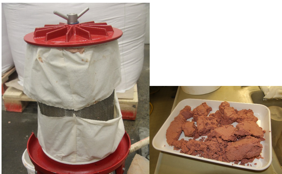
Modificeret æblepresse med filterdug samt filterkage.
