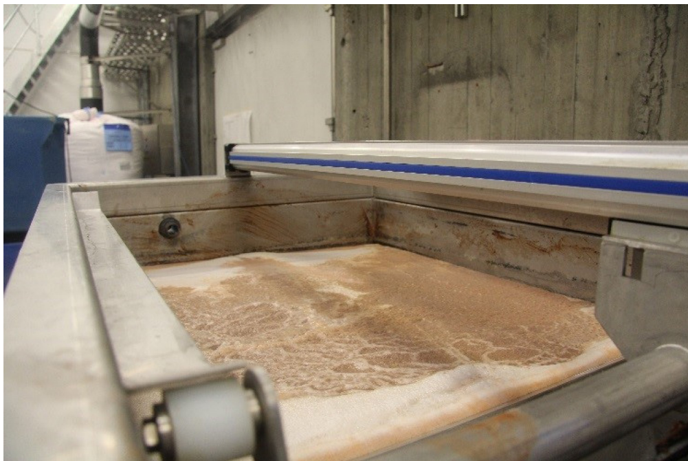
Overfladen af det udviklede flotationsanlæg med skum. Skraberer ses i forgrunden.
