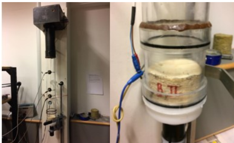
Måloppstilling ved test. Det målte materiale er indsat i bunden af røret. Th ses placering af
