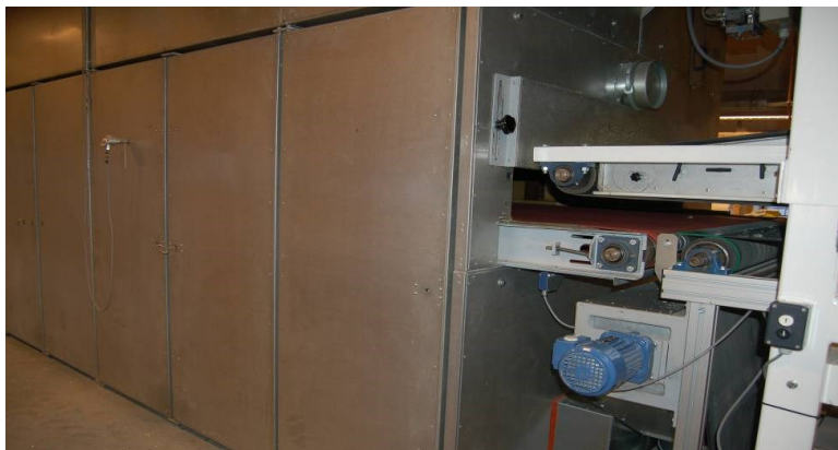
Luftstyret ovn, hvor produktet fixeres uden at kollapse. Herved bevares luft i produktet til brug som isoleringsmåtte. Foto: Bodil E. Pallesen, Teknologisk Institut.
