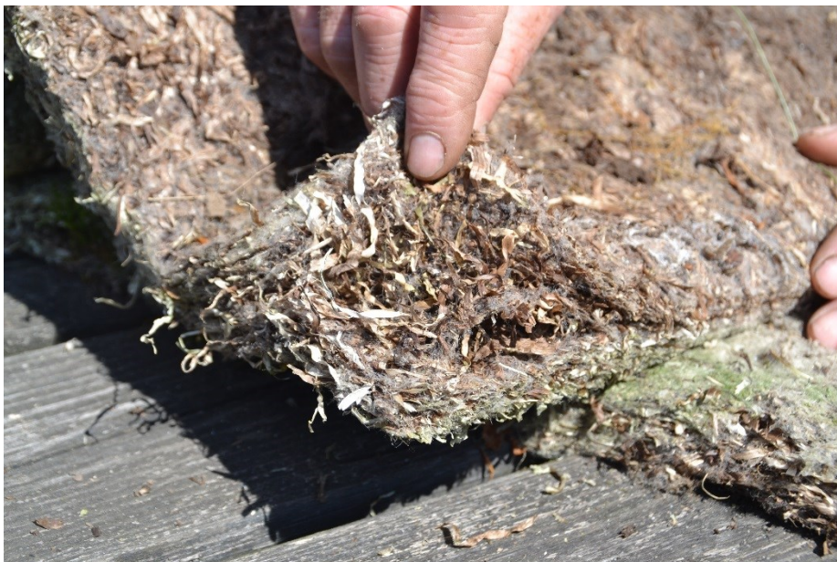
Tangmåtte, der stadig har friske fibre i midten, endskønt det har ligget ude i mere end 10 år, direkte på jorden i Feldballe. Foto: Bodil E. Pallesen; Teknologisk Institut, AgroTech
