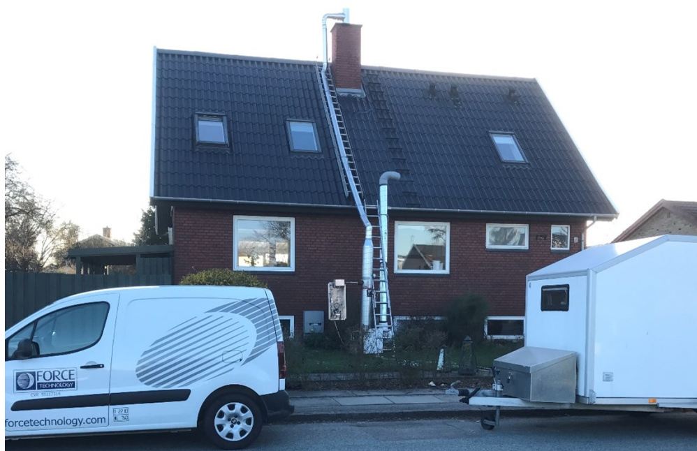
Eksempel på fortyndingskanal monteret på et af husene
