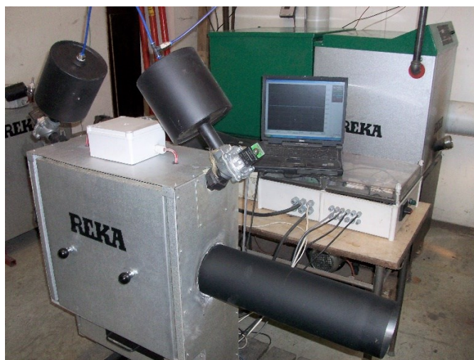
Figur 2. Elektrofilter til mindre pille fyr i ydelsesintervallet 4 – 20 kW. Filtret er med 2 kanaler og opsamlersplader med en diameter på 250 mm.
