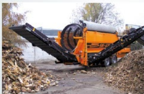
Figur 4: mobil Maskinteknisk løsning til neddeling (langsomtgående) og rensning af HPA-flis (eksempel fra leverandør)
