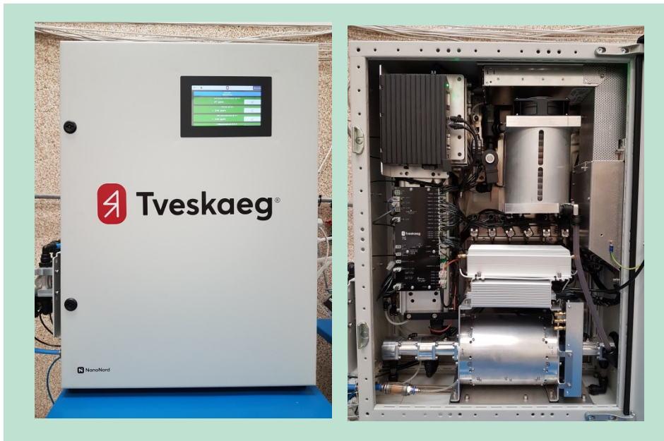
FIGUR 5.2. NMR-målerkabinettet; Lukket til venstre og åbent til højre. Inde i kabinettet ses NMR-magnet i bunden af billedet samt skyllesystem øverst i kabinettet.
