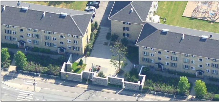
FIGUR 3. Folehaven med støjskærm og lydskodder etableret i 2007 pilotprojektet. Skråfoto er taget fra nord. Det ses, at 14 af 24 lydskodder på billedet er skudt for og 10 skudt helt eller delvist til side. Kilde: Rasmussen B. (2015). Erfaringer med lydisolerede åbne vinduer i trafikstøjbelastede boligområder. SBI rapport 2015:08.
