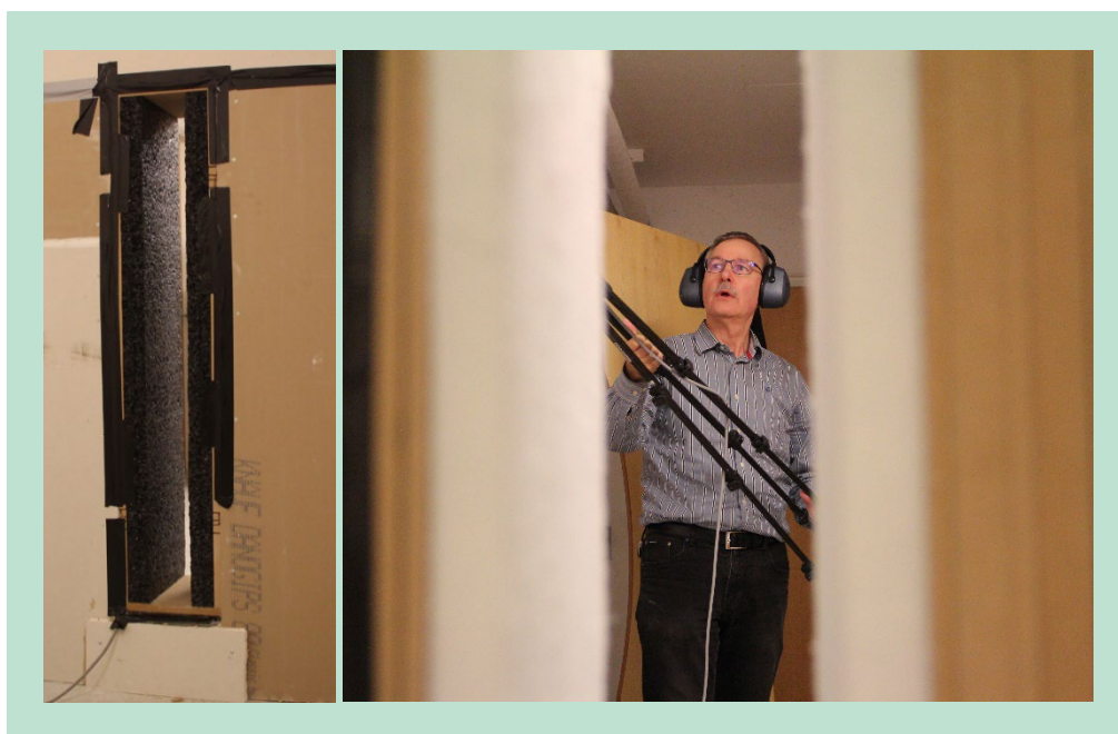
FIGUR 5. Fotos fra målinger af lyddæmpningen gennem lydslusen ved forskellige udformninger og forskellige dæmpningsmaterialer, t.v. selve åbningsspalten med dæmpningsmateriale, t.h. et kig gennem åbningen.
