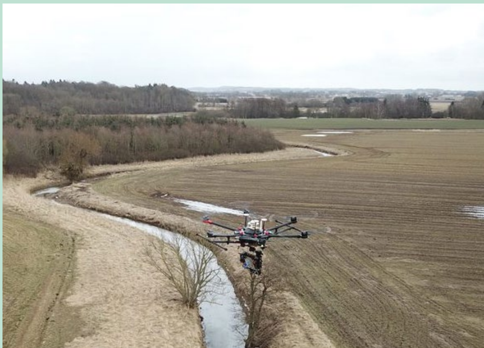
FIGUR 31: Drone i aktion i Åmose å hvor vandspejlet opmåles med radar med påvist nøjagtighed på +/- 2-3 cm. Billedet er stillet til rådighed af Filippo Bandini DTU. Opmålingen er en del af udviklingsprojektet Riverscapes. Kilde: Orbicon A/S.
