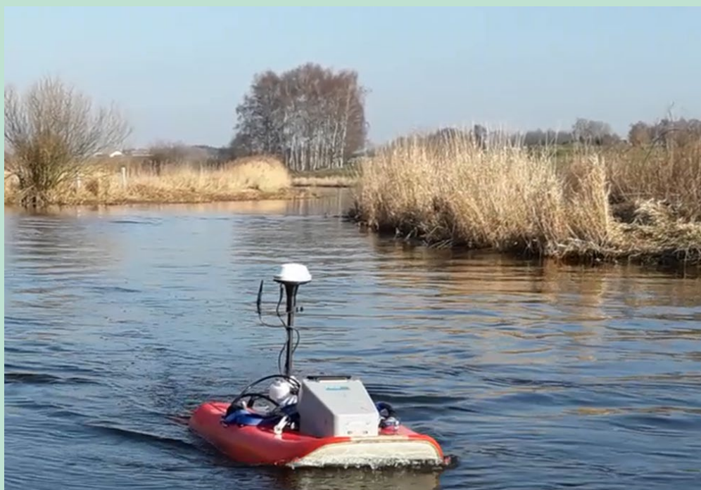
FIGUR 32: Opmåling med en USV i Susåen 2019. Kilde: Orbicon A/S
