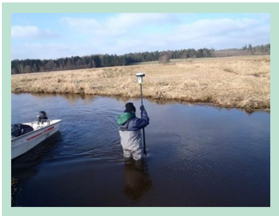
FIGUR 30: Traditionel profilopmåling med GPS
