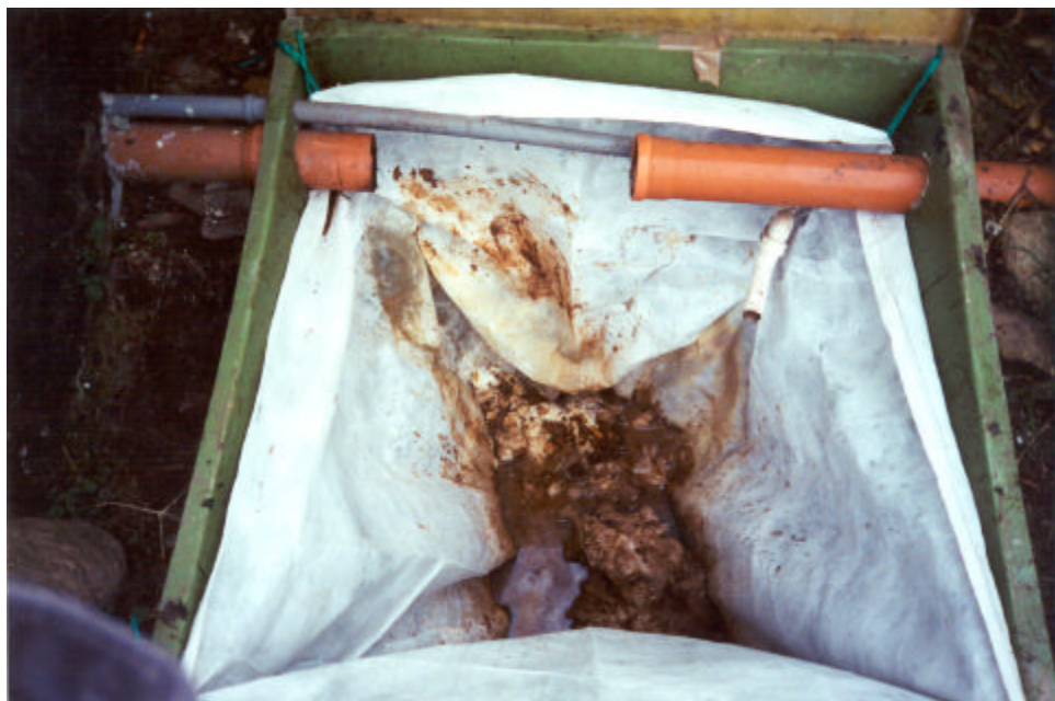
Filterposen er ophængt bedre end i Kaggen 1 og Kaggen 2
