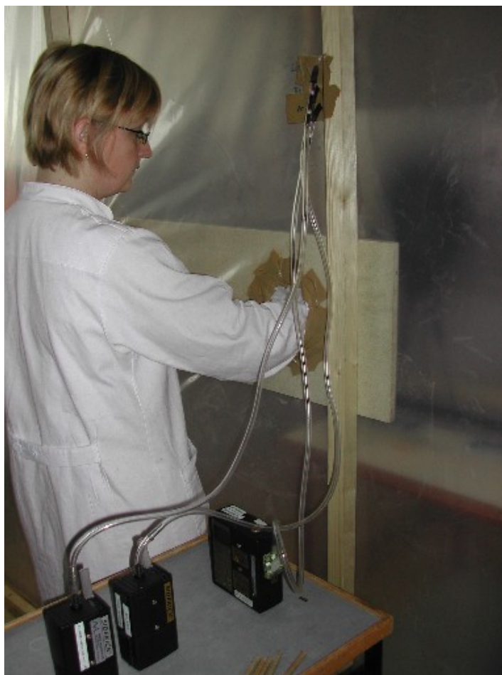
Foto 5: Påføringsforsøget set udfra, hvor princippet til opsamling af luftprøver ses. Kulrørene sidder i huller i kabinens folie. Modelfoto.
