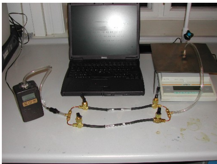
Foto 6: Opstilling til tørreforsøg. Det malede emne ligger på vægten til højre. Over vægten ses låget, hvorfra luften suges igennem kulrør. Kulrørene ligger i forgrunden. Systemet med parallelle kulrør er lavet for at kunne holde en konstant lav luftstrøm henover emnet samtidig med, at det er muligt at udskifte kulrørene efter hver opsamlingsperiode på 30 sekunder. Modelfoto.
