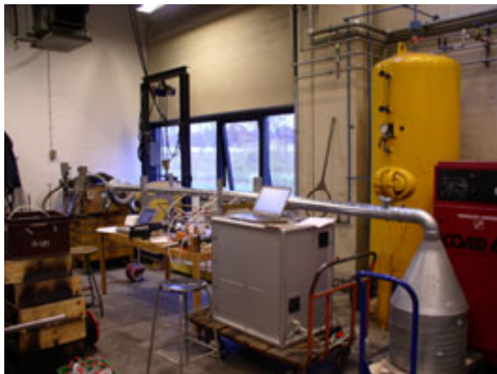
Figur 9.1.1. Viser testopstilling med enhætte, MIMS'en og filteropsamlings- og PID-udstyr
