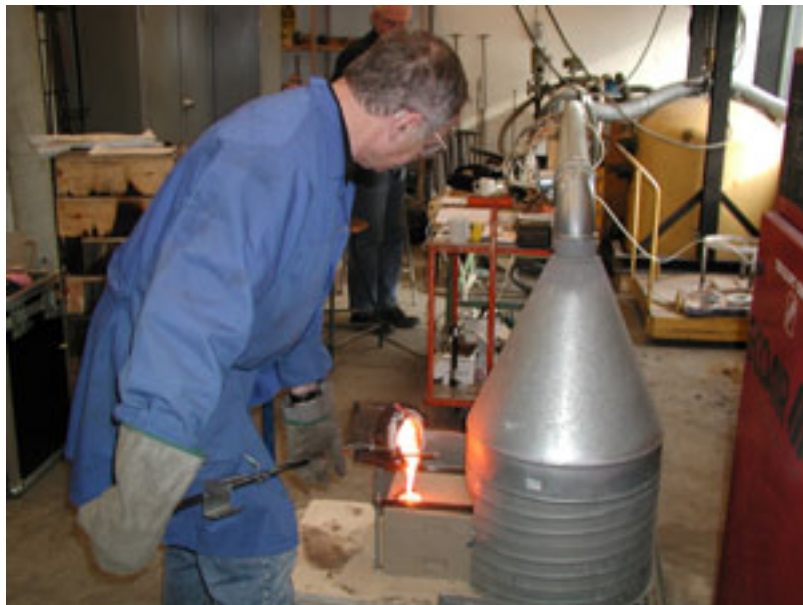
Figur 5.1.2: Støbning med højsolert keramisk håndske, rumfang ca. 1,5 l metal
