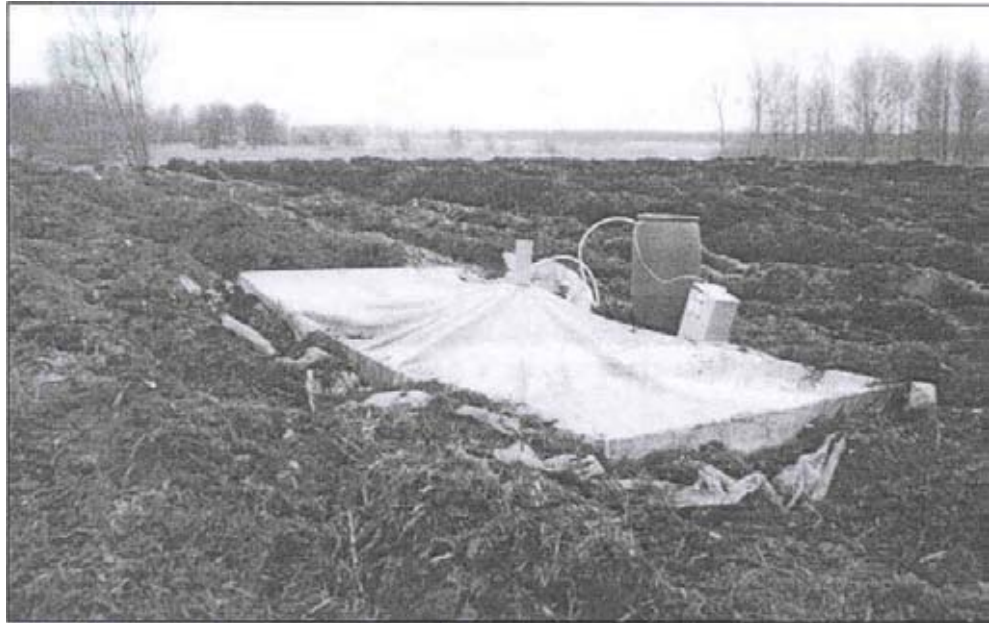
Figur 7 Statisk fluxkammer til bestemmelse af lugtkoncentration på en kompostmølle. Her illustreret ved telmetoden 26
