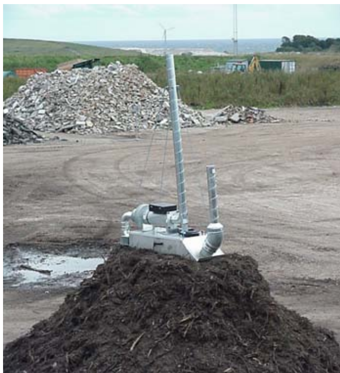
Figur 6. Vind tunnel til lugtbestemmelse på faste arealkilder
