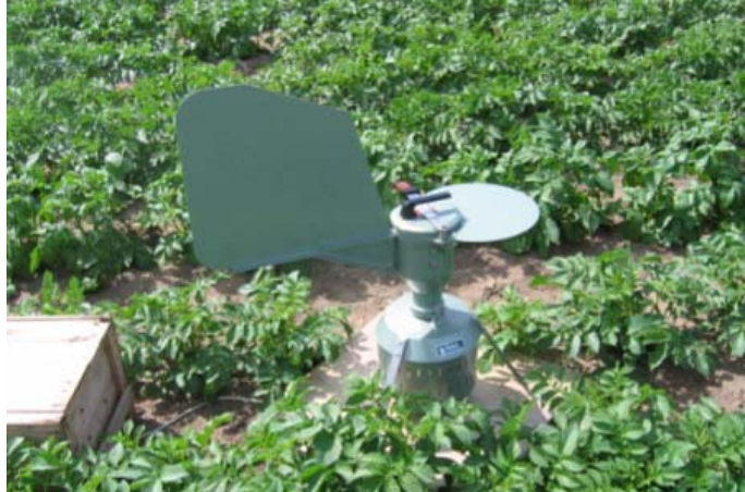
Figur 7. Burkard sporefælde opsat i sortsblandingen Flakkebjerg i 2005. Fælden har et haleror, som sikrer, at indsugningen, som befinder sig under den cirkulære, horisontale metalskive, vender mod vinden. Smitsstof i form af sporangier suges ind i fælden ved hjælp af en motor, der i princippet virker som en støvsuger.
