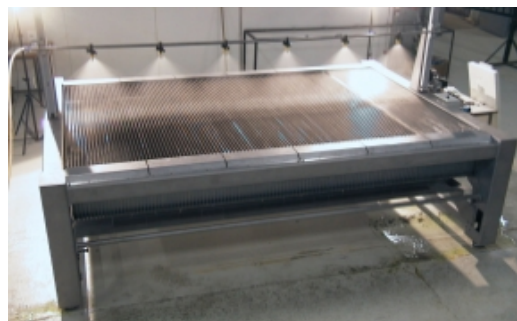
Figur 25. Måling af væskefordeling ved brug af et stationært fordelerbord
