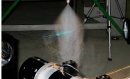
Figur 23. Krydsningsfeltet mellem de 2 laserstråler, hvor dråbeanalysen finder sted
