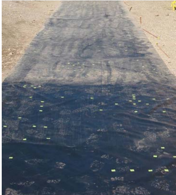
Figur 20. Sprøjtebanen, der blev anvendt til demonstration af celledsprøjten med påmonteret kunstige "ukrudtsplanter"
