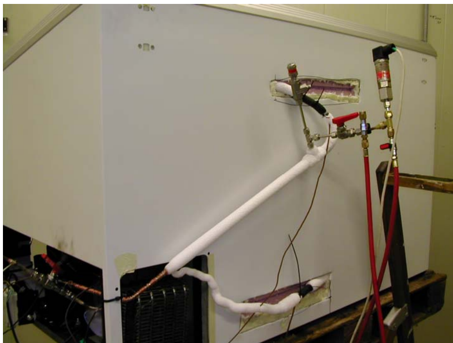
Figur 7 Iscremefryseren set skråt "bagfra". På dette foto var sugeledning og intern varmeveksler endnu ikke isoleret. Derfor er der is på rørene. Man ser også sikkerhedsventil og tryktransducer (øverst til højre). Nederst til venstre er kompressorrummet.
