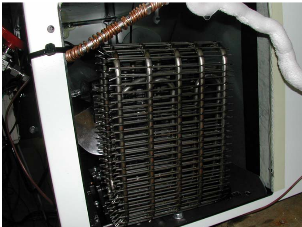
Figur 6 Den første del af gaskøleren er leveret af Bundy A/S. der er tale om en bukket wire on tube-kondensator". Både denne og kompressoren bliver kølet af en blæser, som også anes bagved.
