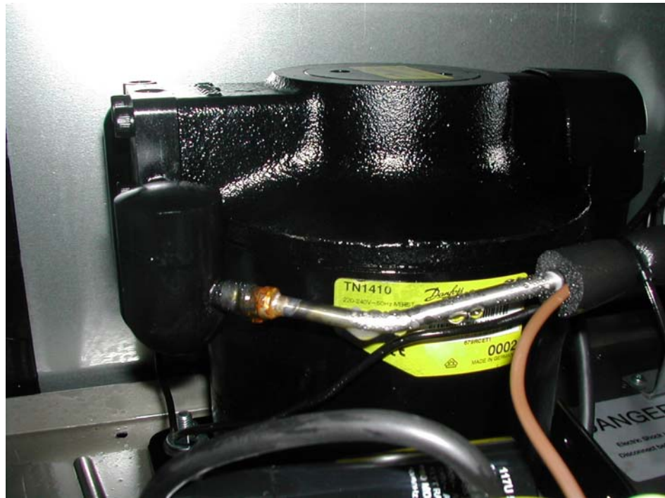
Figur 3 Kompressor TN1410 fra Danfoss
