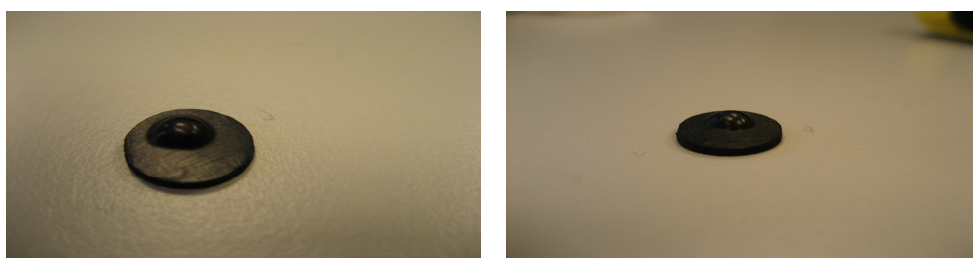
Figur 20: N8805-90 efter forsøg under 50 [bar] og 20 °C.
