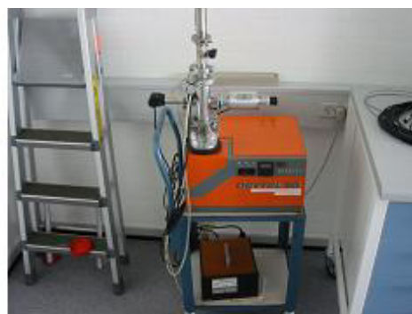
Figur 8: Til venstre - Højtrykssvægt; til højre - Vakuumpumpe.
