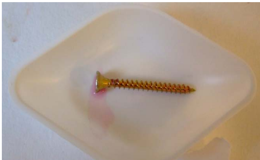
Figur 2.8 skrue p1 kraftig farvning med karakteristisk violet-røde farve –indikerer et højt indhold af krom(VI)
