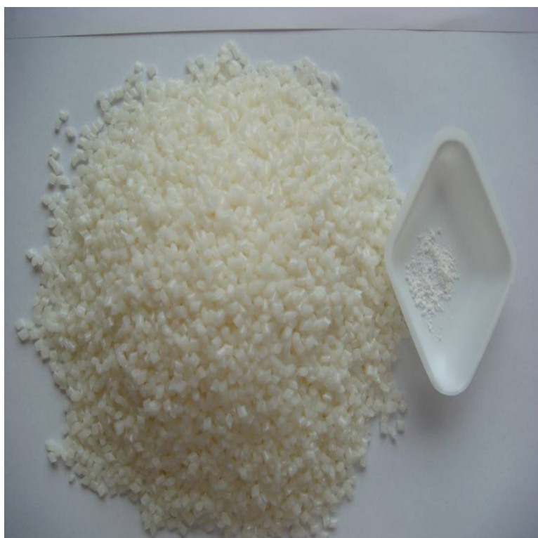
Figur 1.15 ABS-plastgranulat og deca-BDE til fremstilling af reference-ABS med 0,1 % Deca-BDE
