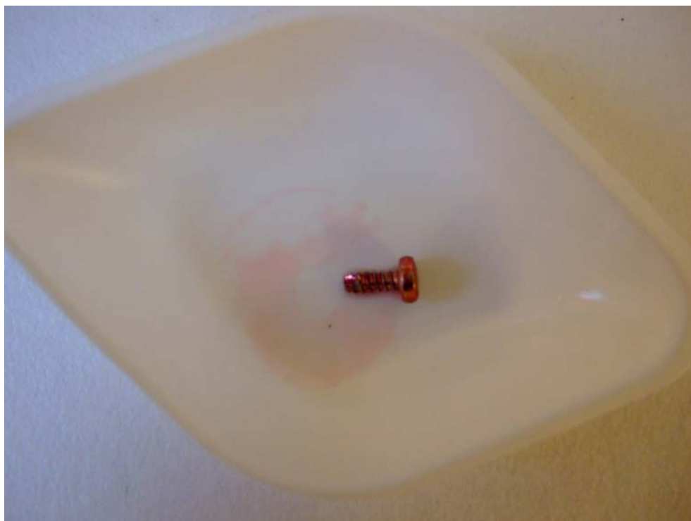
Figur 2.5 9C rød skrue som afgiver rød-violet farve til en plast vejebåd (vejebåden giver ingen respons i sig selv).
