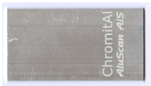
Figur 2.16 p8 Chromital –Aluminium med trivalent Krompassiverings overfladebelægning. Der opnås Ingen reaktion i spottest og ingen bobleudvikling hvoraf konkluderes at emnet ikke indeholder krom(VI).
