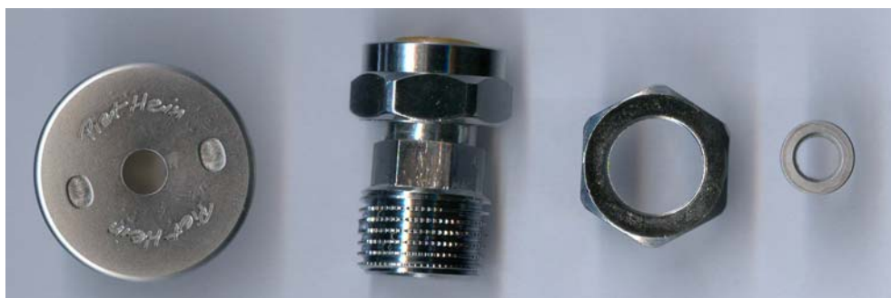
Figur 2.17 P9 Diverse kromaterede emner fra ÅKchrom. Der opnås Ingen reaktion i spottest og ingen bobleudvikling hvoraf konkluderes at emnet ikke indeholder krom(VI).
