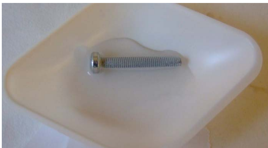
Figur 2.20 B&O krom(VI)-fri skrue ala p3. Der opnås ingen farvereaktion i fortyndet spottestvæske hvorfor der når der sammenlignes med Figur 2.11 konkluderes at skruen ikke indeholder Krom(VI).
