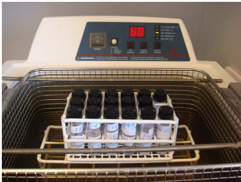
Figur 1.19 Ultralydsbehandling af ekstrakter fra referenceplasttyper med tilsat kendt mængde af deca-BDE
