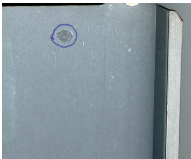
Figur 2.18 krom(VI) fri referenceplade el galvaniseret efter EN10152 krom(VI) fri fra B&O. Der opnås Ingen reaktion i spottest og ingen bobleudvikling hvoraf konkluderes at emnet ikke indeholder krom(VI).
