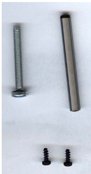
Figur 2.19 Krom(VI)-frie emner fra B&O. Der opnås Ingen reaktion i spottest og ingen bobledvikling hvorefter konkluderes at emnet ikke indeholder krom(VI).
