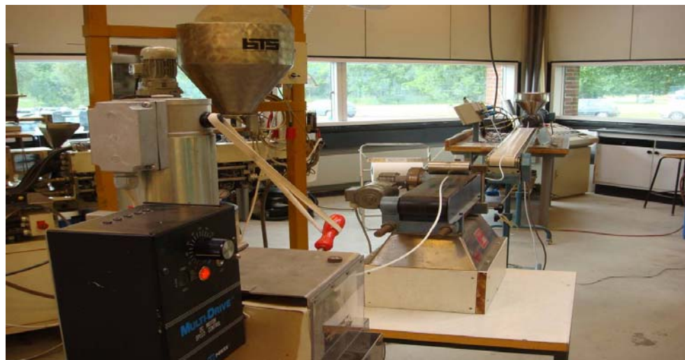
Figur 1.13 Forsøgsopstilling til fremstilling af referenceplasttyper med kendt indhold af flammehæmmere
