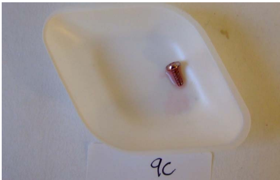
Figur 2.6 9C anden tilsvarende skrue med rød-violet farvereaktion.
