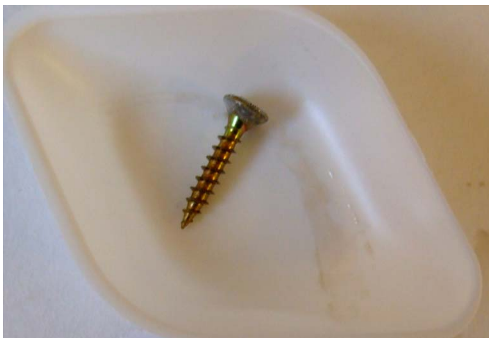
Figur 2.15 Skrue af typen p7 Der observeres ingen rødfarvning hverken i spottestvæske eller i fortyndet spottestvæske. Det konkluderes at skruen ikke indeholder Krom(VI)
