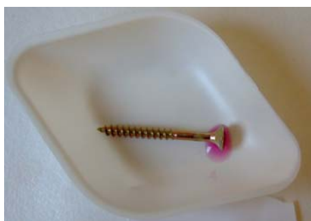
Gulkromateret skrue med testopløsning. Den karakteristiske violet-røde farve indikerer indhold af krom(VI)
