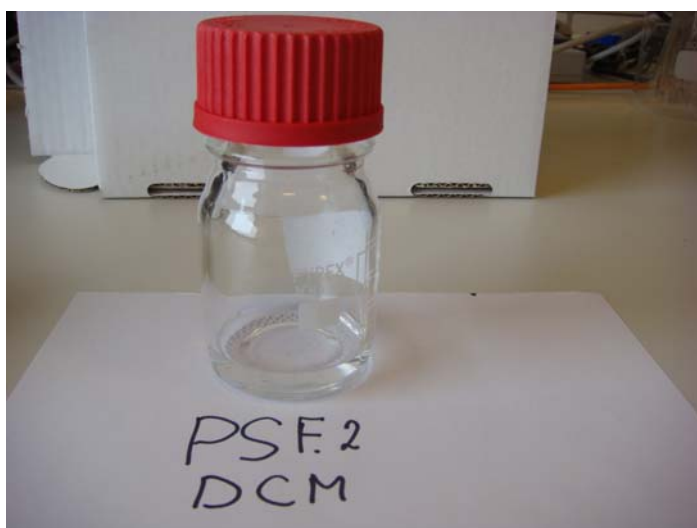
Figur 1.21. Ekstraktionsforsøg på reference-PS med tilsat deca-BDE på 1 %. Bemærk, at plasten går helt i opløsning
