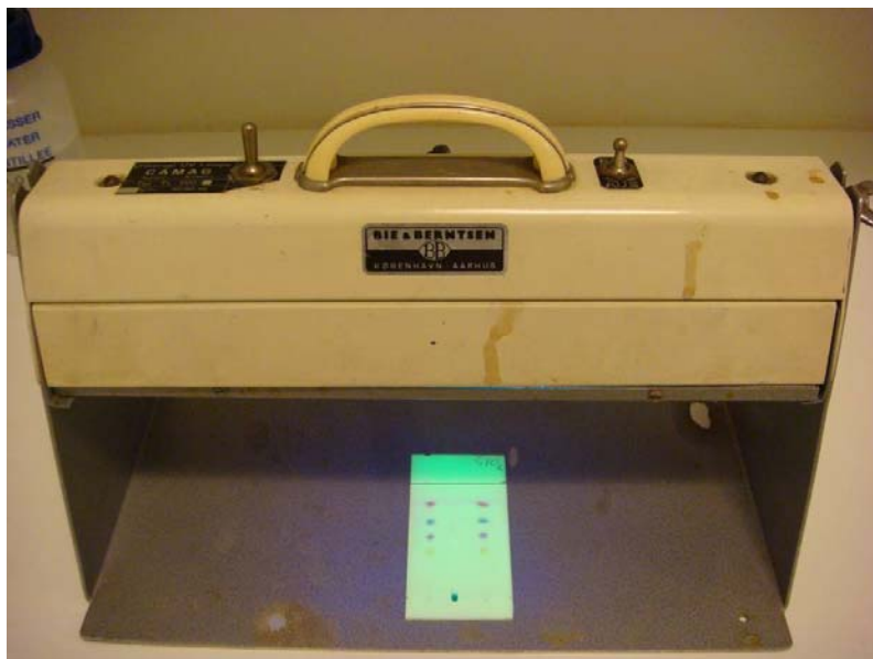
Figur 1.6 Visualisering under UV- lampe ved 254 nm UV-lys
