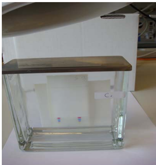
Figur 1.4 Påbegyndende separation af farvestoffer
