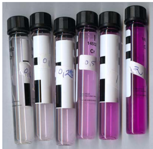
Figur 3 Farveskala - væsker til kalibrering Koncentrationer fra venstre i ppm: 0,05/0,1/0,2/0,5/1/2.
