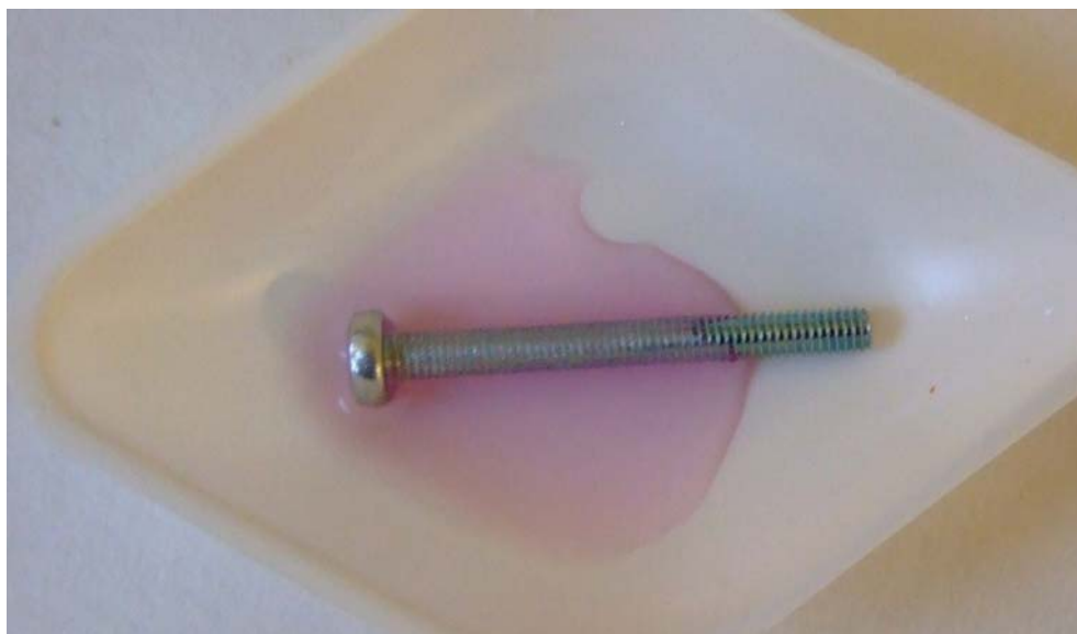
Figur 2.11 P3 blåkromateret skrue udsat for fortyndet spottestvæske. Der observeres en middelkraftig karakteristisk violet-rød farvning. Dette indikerer at skruen indeholder krom(VI).
