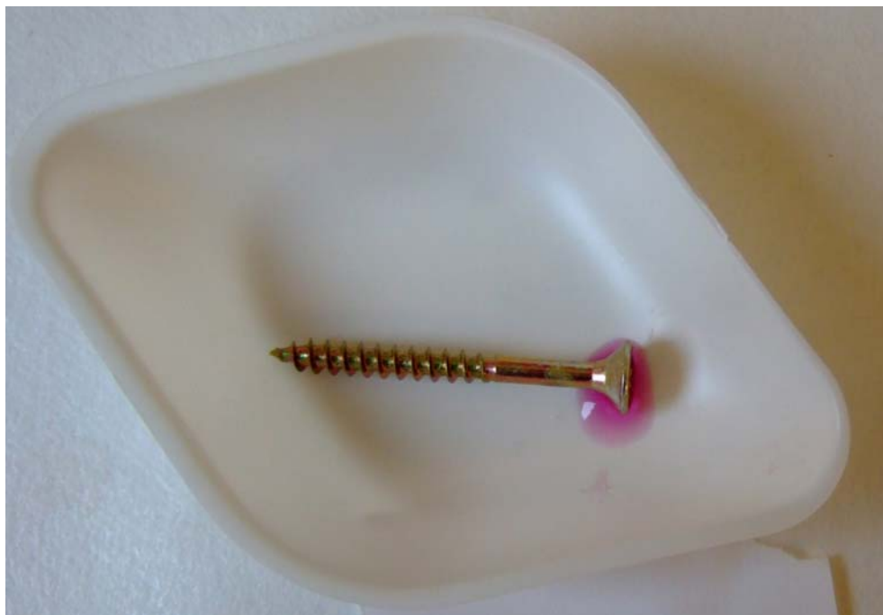
Figur 2.12 gulchromateret skrue af typen P4. Den karakteristiske violet-røde farve indikerer højt indhold af krom(VI)
