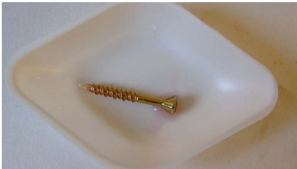
Figur 2.14 Gulchromateret skrue af typen p6 skruen udviser en middel kraftig farvning med karakteristisk violet-rød farve, hvilket indikerer et vist indhold af Krom(VI)
