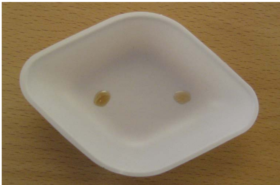
Figur 2.7 Spottestvæsken ændrer farve med tiden. Ny væske er næsten klar. Til højre er ca 1½ måned gammel væske som er blevet kraftigere brunfarvet efter 3 måneder (til venstre)
