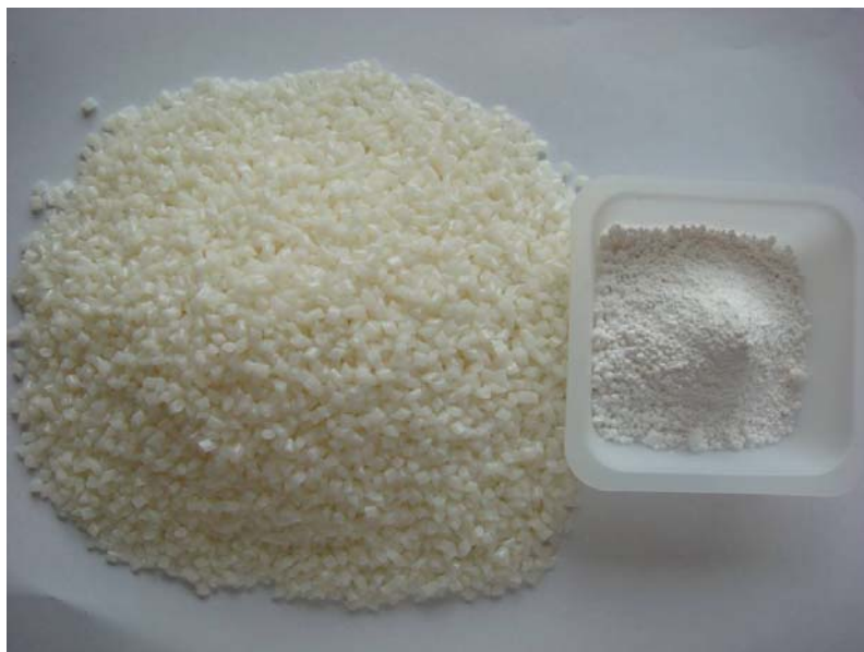
Figur 1.16 ABS-plastgranulat og deca-BDE til fremstilling af reference-ABS med 13 % Deca-BDE
