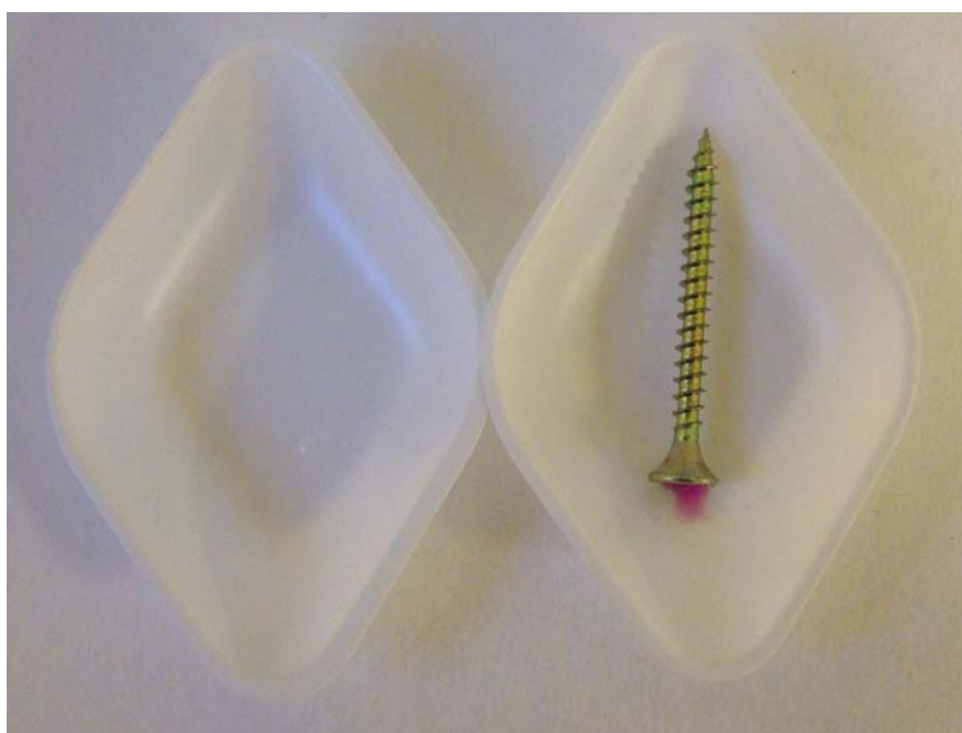
Figur 2.9 Skrue p2 i plastvejskål med kraftig farvning, samt plastvejbåd (p11) uden reaktion på spottest. Den karakteristiske violet-røde farve indikerer højt indhold af krom(VI)
