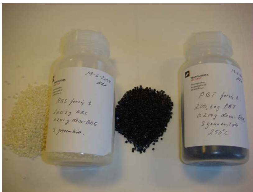
Figur 1.17 Fremstillede referenceplastmaterialer i ABS og PBT (sort) med 0,1 % deca-BDE
