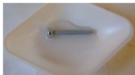
Krom(VI)-fri skrue. Der opnås ingen farvereaktion i testopløsning eller fortyndet testopløsning.
