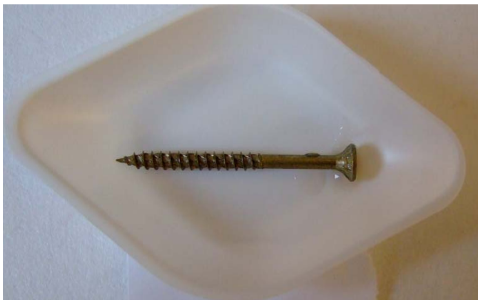
Figur 2.13 Skrue af typen P5. Der observeres ingen farvning i ufortyndet spottest væske og ingen bobler hvilket indikerer at skruen ikke indeholder krom(VI)
