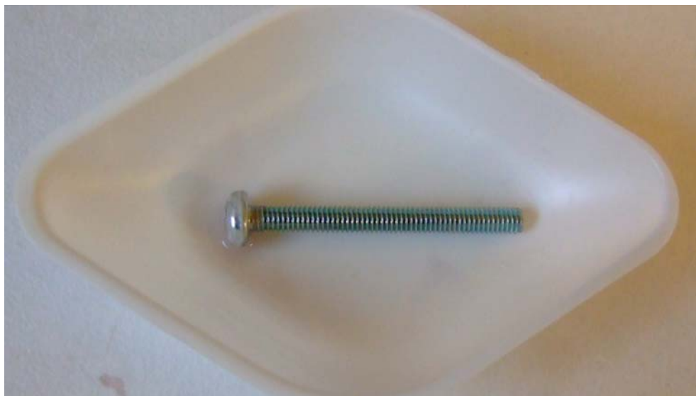
Figur 2.10 P3 blåkromateret skrue spottet væske meget lille grad af rødfavning . Der kan ikke konkluderes at der findes krom(VI) ved brug af spottestvæsken i normal koncentration.
