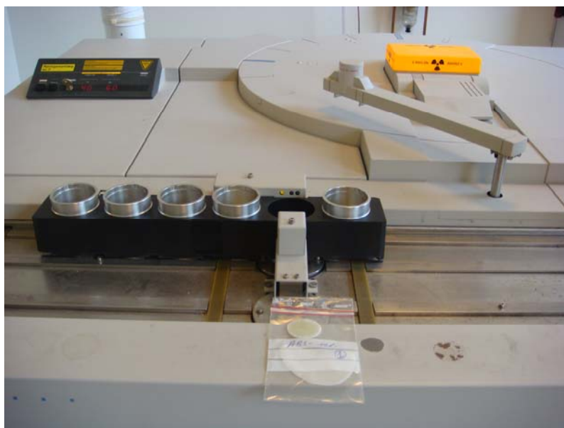
Figur 2.28 WDXRF-udstyr. Referenceoblater til bestemmelse af brom i plast ses forrest i billedet
