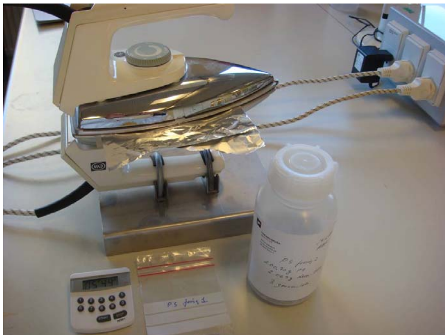
Figur 1.18 Prøveforberedelsesstand til fremstilling af testoblater til røntgenanalyse
