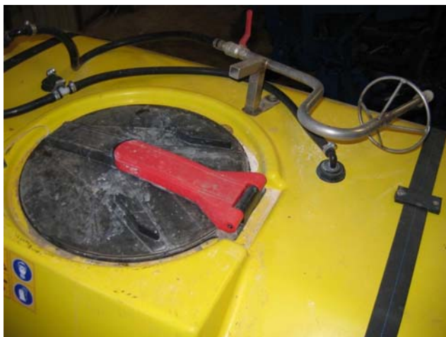
Tågesprøjte med montering af en udvendig spuledyse, som gør det muligt af skylle tom emballage. Påfyldning af koncentreret bekæmpelsesmiddel og skyllevand sker direkte gennem åbningen i sprøjtetanken. Foto: Niels Enggaard Klausen.
