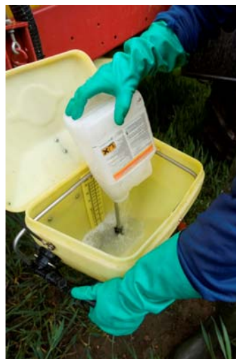
En spuledyse sikrer en nem og sikker skylning af tom emballage. Foto: Jens Tønnesen, Dansk Landbrugs Medier.
