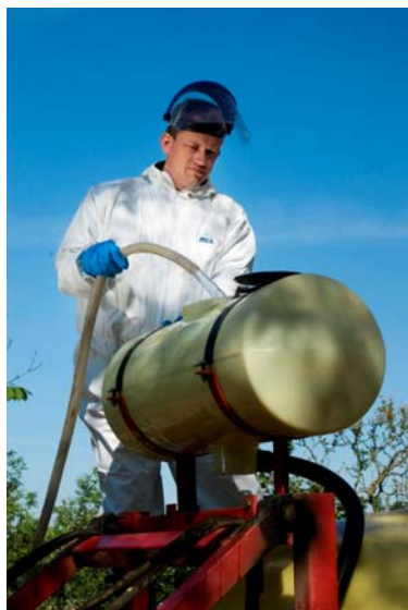
Skyllevandstank eftermonteret på en marksprøjte. Foto: Jens Tønnesen, Dansk Landbrugs Medier.
