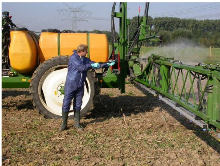
Udvendig vask af marksprøjte i marken. Foto: TOPPS.
