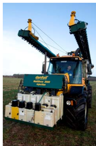
Marksprøjte med injektionssystem. Foto: Jens Tønnesen, Dansk Landbrugs Medier.
