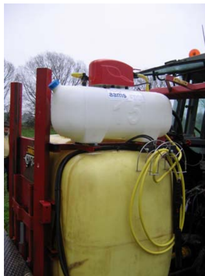
Rengøringsæt med skyllevandstank, spuledyse og rengøringslanse til eftermontering. Foto: Niels Enggaard Klausen.
