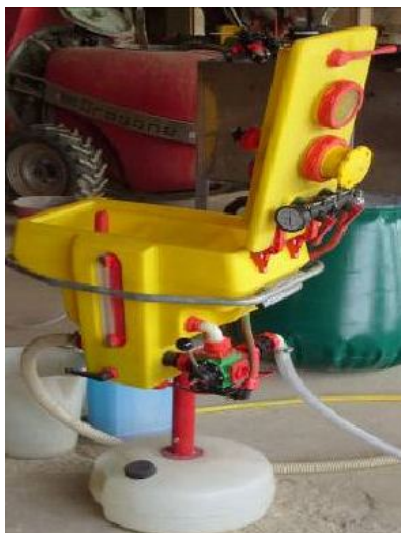
Præparatfyldeudstyr, hvorfra plantebeskyttelsesmidlerne suges op i sprøjten. Foto: TOPPS.
