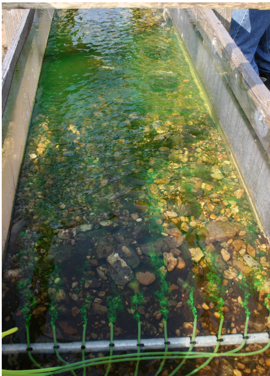
Figur 2.1.7. Ved brug af grønt farvestof er her vist, hvorledes der over en 90 min's periode blev doseret lambda-cyhalothrin i en koncentration på 5,0 \mu\text{g l}^{-1} til den nedre halvdel af tre af de 6 forsøgsrender i Lemming. Det ses, at farvestoffet opblandes effektivt allerede få cm nedstrøms for doseringsstedet.
