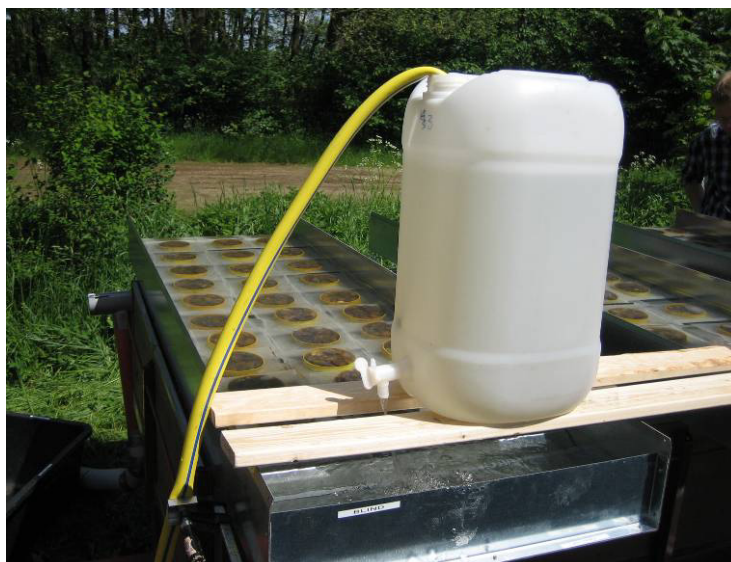
Figur 2.1.4. De kunstige substrater (her gruskopper) blev efter en indledende koloniseringsperiode taget op af det enkelte forsøgsvandløb og (bortset fra 6 såkaldte før-prøver) fordelt tilfældigt i tre forsøgsrender. Mens den ene rende fungerede som kontrol og fik tilført alm vand, fik de to øvrige tilført vand med tilsat lambda-cyhalothrin i koncentrationer på hhv. 0,5 og 5,0 \mu\text{g l}^{-1} . Denne eksponering varede 90 min., hvorefter substraterne (bortset fra 6 fra hver rende, der straks blev konserveret) blev genudlagt i vandløbet. På billedet ses nærbillede af kontrolrenden. Hver gruskopper anbragt i et net til opsamling af smådyr, som måtte forlade substratet før, under og efter eksponeringen. Der pumpes vand op i plastbeholderen, hvorfra det løber til forsøgsrenden, der har afløb i den fjerneste ende.
