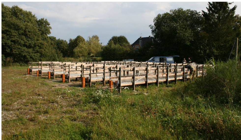
Figur 2.1.5. Oversigt over de 6 forsøgsrender (kunstige vandløb) i Lemming. Hver rende er 12 m lang, anbragt på bukke af træ, og har en hældning på 5 ‰.
