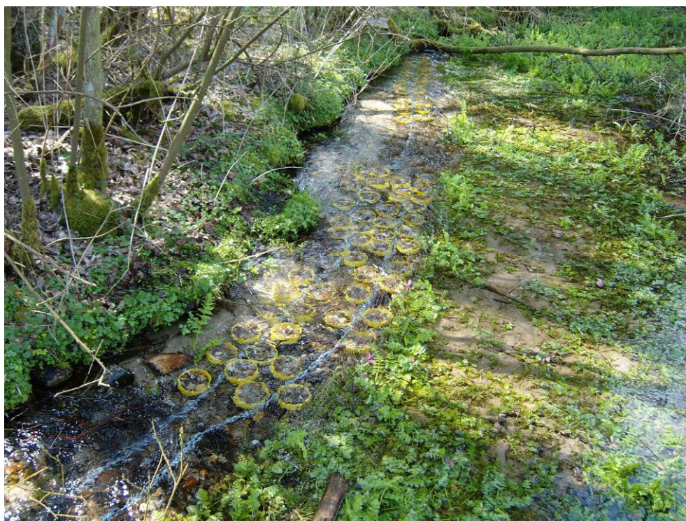
Figur 2.1.1. Kunstige substrater, her gruskopper (plasticbeholdere indeholdende groft grus), udlagt i Hagenstrup Møllebæk. De enkelte gruskopper var individuelt mærket og fastgjort til jernkæde med plaststrips.
