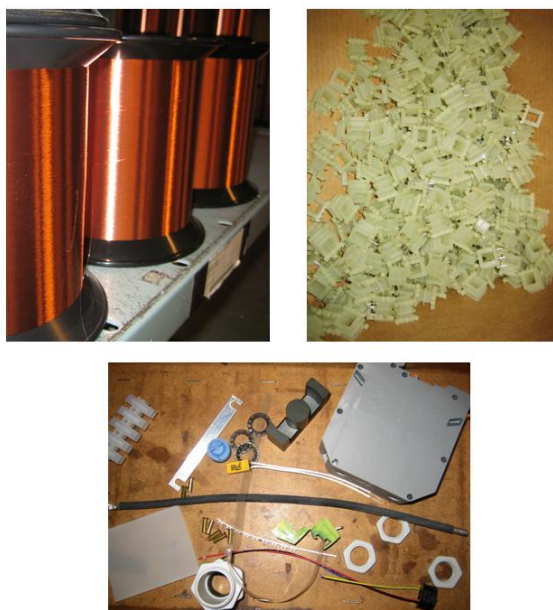
Figur 3 Antallet af forskellige indkøbte artikler i en transformator kan overstige 1000
