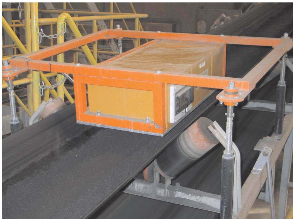
Figur 1. XRF-teknologi fra Bruker Baltic til online identifikation og koncentrationsmåling af mineraler i malm på et transportbånd
