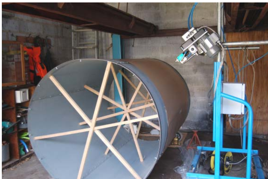
Fig. 4) Forsøgsopstillingen. Tromlen er 1250 mm Ø og 2000 mm lang. Den kan rotere med en periferhastighed fra 2 m/min til 16 m/min. Hovedparten af forsøgene blev udført ved 4 m/min. Tromlen dækkes med brunt indpakningspapir (fidele), som skiftes for hvert forsøg. Til højre på det blå stativ ses traversen som kan reciprocere (køre frem og tilbage) godt 500 mm med trinløst variabel hastighed. Pistolen kan aktiveres enten i én af yderstillingerne eller i begge så der sprøjtes henholdsvis den ene vej, henholdsvis både ud og hjem.
