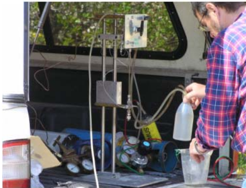
Figur 5. Udtagning af vandprøver til CFC-analyse (øverst) og tritium (nederst). Ved udtagningen til CFC-analyse gennemskylles glasampullen med rensket kvælstof før fyldning med vand fra boringen, hvorefter ampullen lukkes ved smeltning. Tritium udtages fra samme oppumpning af vand.
