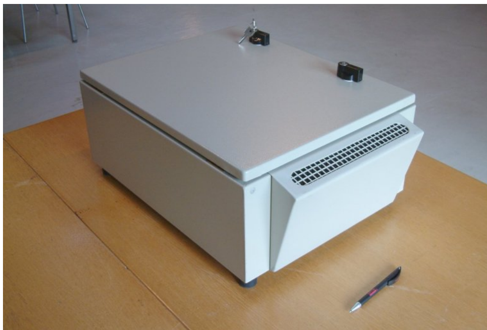
Figur 2.1 Luftrensere. De ydre mål er ca. 60 x 40 x 30 cm og vægten er ca. 29 kg
