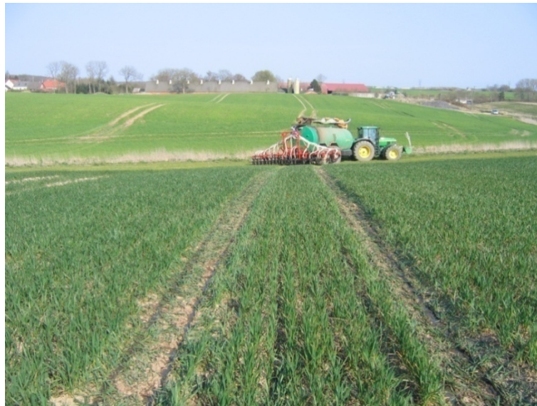
Figur 5. Ved nedfældning hæmmes afgrøden mellem køresporerne af hjultrykket. I forsøg er køreskaden opgjort til 2,9 hkg per ha mere end ved slangeudlægning. Foto: Jens Johnsen Høy, AgroTech.
