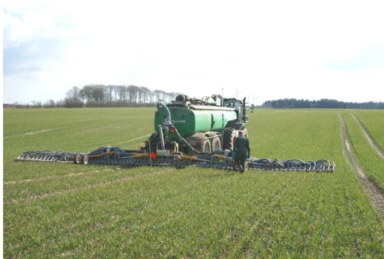
Figur 9. 16 meter bom fra Slootsmid i Holland. Bommen er forsynet med slæbesko. Foto: Torkild Birkmose, Landscentret.
