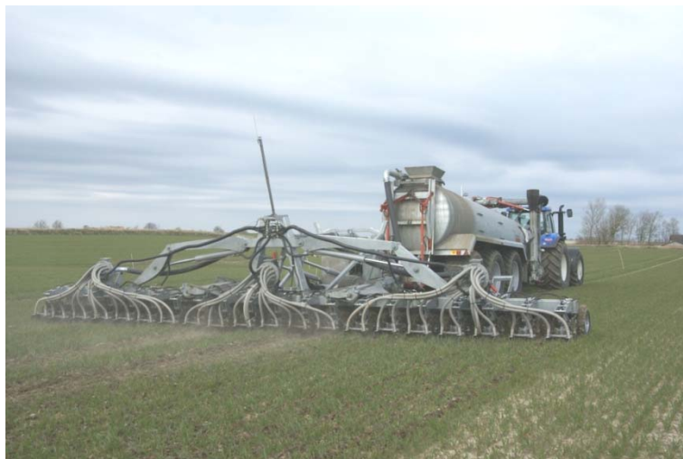
Figur 8. 12 meter bred nedfælderbom fra Harsø Maskiner. Nedfældereren er bugseret, og den kan efterlades i marken under genfyldning af vognen, så vejtransport minimeres. Foto: Torkild Birkmose, Landscentret.
