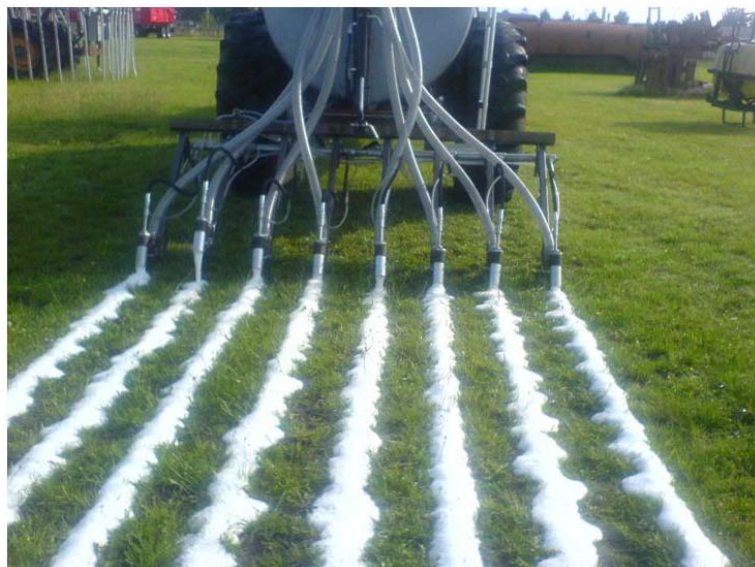
Figur 12. Biocover fra Thyregod. En forsuret og stabiliseret skum dannet af gylle lægges over den slangeudlagte gylle. Foto: Thyregod.
