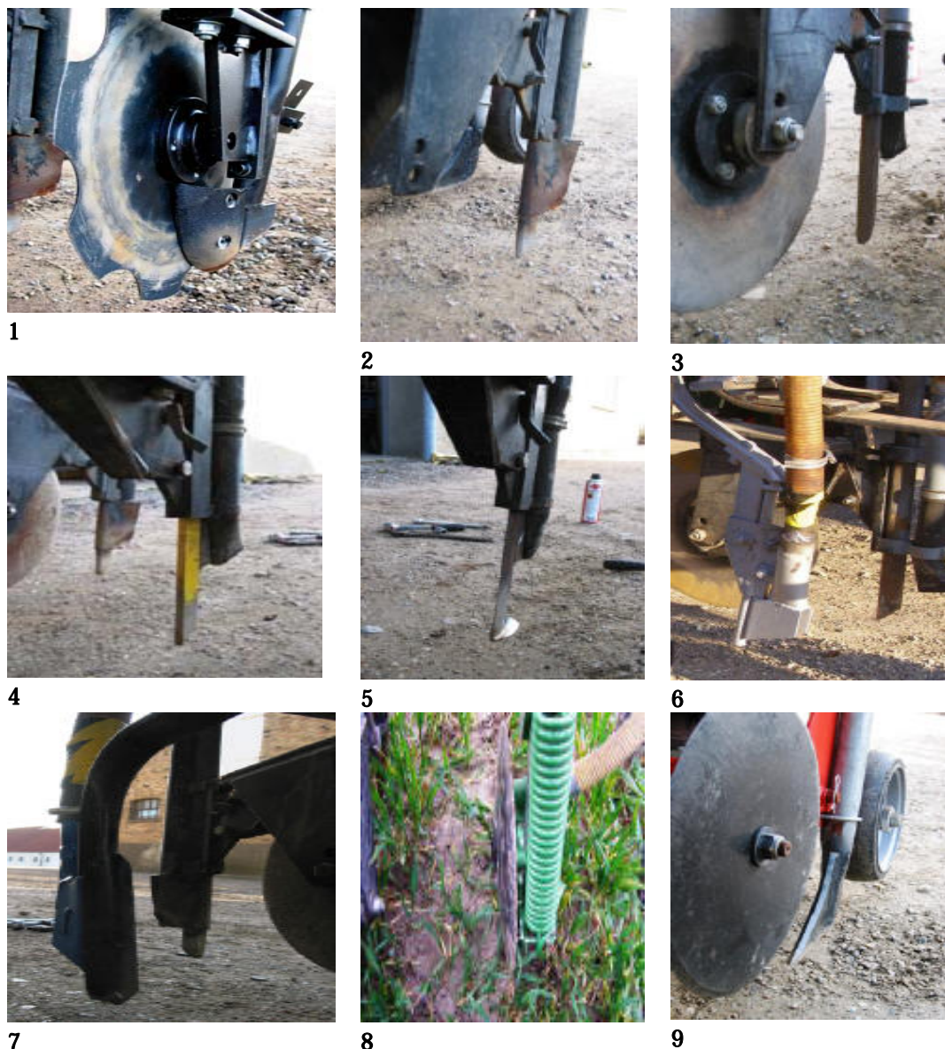
Figur 2. Fotos af nedfældningssystemer, som potentielt kan benyttes til nedfældning i vintersæd. De viste systemer er evalueret med hensyn til deres evne til at kunne sikre nedfældning i afgrøder uden at skade afgrøden. De indsatte tal henviser til nr. i tabel 2. Kilde: Høy, 2007.
