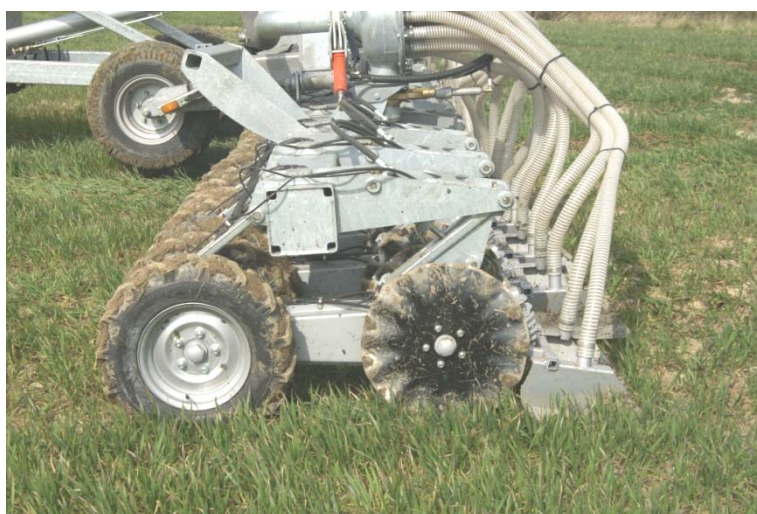
Figur 7. Bremseskær fra Harsø Maskiner. Via en gearkasse bremses det forreste gummi hjul (til venstre) det bageste bølgeskær ned til halv hastighed, og der pløjes en 4-7 cm dyb og 2-3 cm bred rende, hvori gyllen placeres. Foto: Torkild Birkmose, Landscentret.
