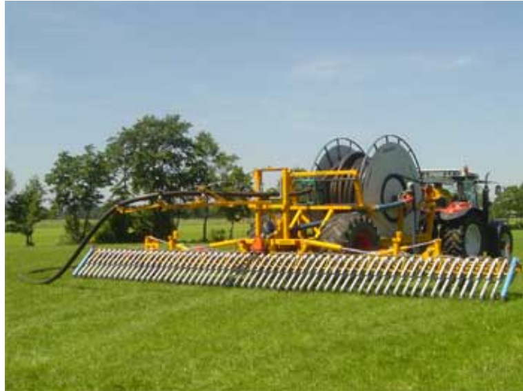
Figur 10. Bom på 12 eller 16,5 meter fra Agrometer. Kan leveres med enten slæbesko eller rulleskær. Foto: Agrometer.
