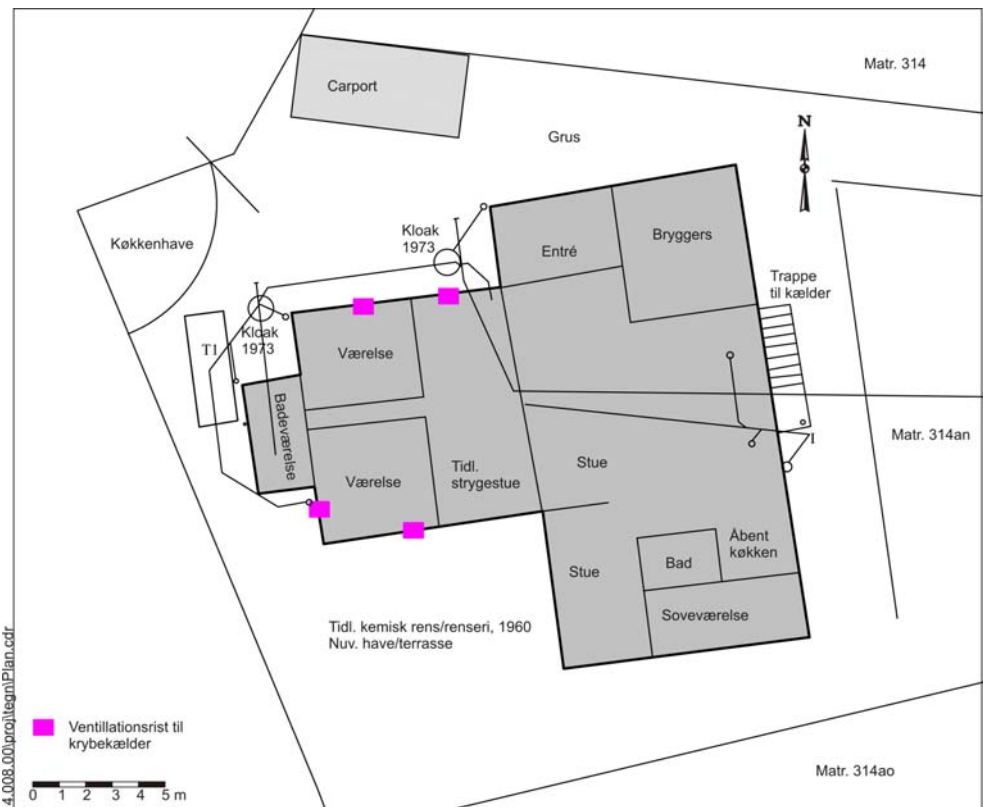
Figur 6.17: Placering af ventilationsriste i fundament for udluftning af krybekælder. Birkevænget i Slagelse.
