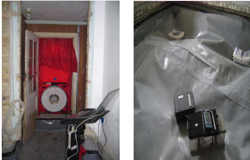
Figur 6.28: Blower door (tv.) og membran ved undertryk på 50 Pa (th.). Østergade i Skuldelev.
