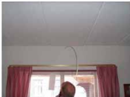
#7 Test 6: Udlledning af sporgas under loft i stuelejlighed 13B.
