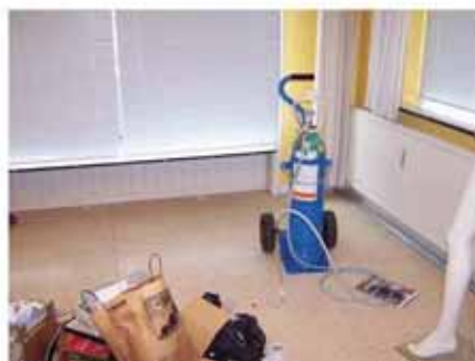
#8 Test 6: Udledning af sporgas i hulrum imellem underliggende betongulv og øvre trægulv (PL8).
