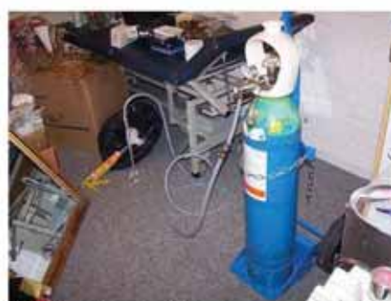
#4 Test 3: Udledning af sporgas under betongulv i PL20.
