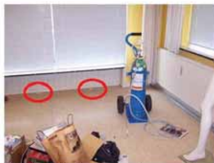
#32 Test 6: Indtrængning af sporgas i to punkter under vindue i den tidligere frisørsalon (rødt niveau).
