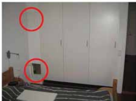
#35 Test 6: Indtrængning af sporgas i kabel-/målerskab i soveværelset i lejlighed 13G (rødt niveau).
