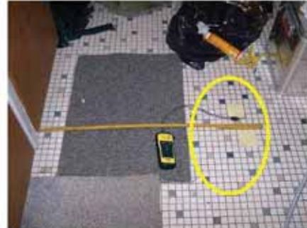
#26 Test 5: Optrængning igennem gulvet i bryggerset (gult niveau).
