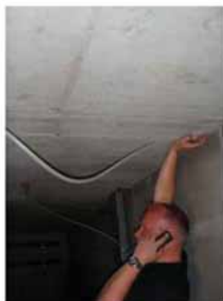
#6 Test 5: Udledning af sporgas under loft i krybekælder.
