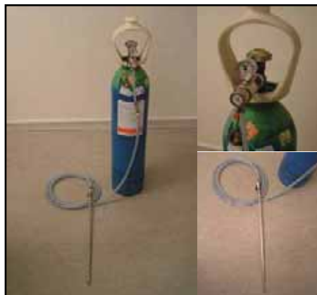
Figur 2.1: Gas, klikventil, slange og poreluftspyd til udledning af sporgas.
