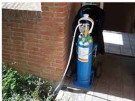
#1 Test 1: Udledning af sporgas i ventilationsdræn I3/I4.
