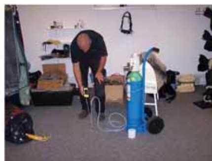
#2 Test 2: Udledning af sporgas i PL12 og kontrol af tætning omkring injektionsspyd.
