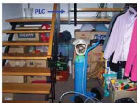
#11 Test 7: Udledning af sporgas i PL9 i trappeopgangen. PLC er benyttet som kontrolpunkt i Test 8. Opmagasineret under trappen.
