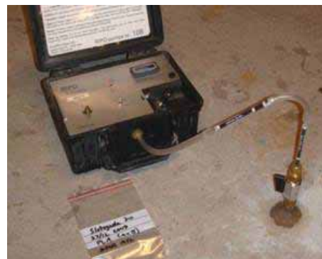
Figur 4.3: Poreluftmåling under kældergulv på Slotsgade.
