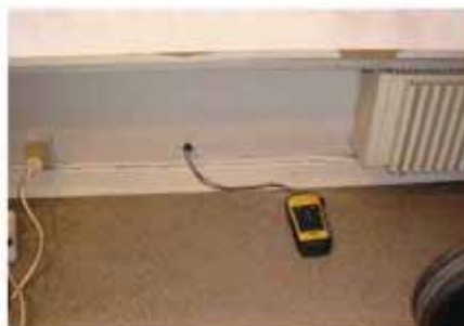
#4: Detektion af sporgas bag skalvæg ved frisør.
