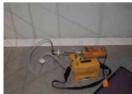
Figur 4.8: Poreluftscrening med PID-måler (Adelgade).
