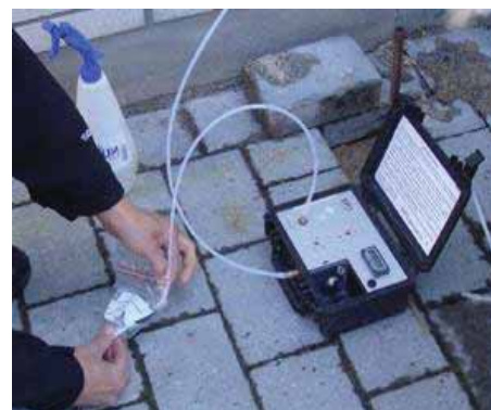
Figur 3.5: Pumpe og flowcelle til måling under specielle omstændigheder.
