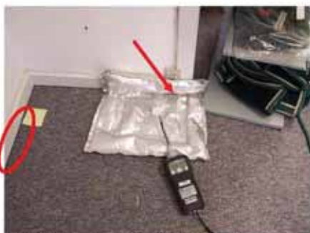
#31 Test 1: Kontrol af indtrængningspunkter ved PL1 med ppbRAE og Vaporco-ver i område med rødt niveau.
