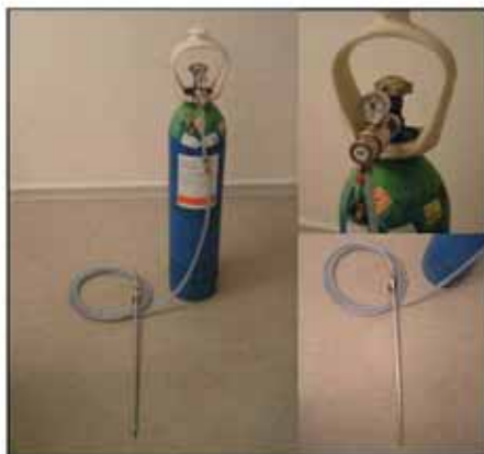
Figur 1: Gas, slange og poreluftspyd til udlledning af sporgas.
