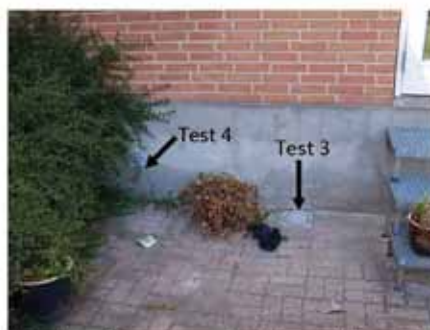
#4 Test 3: Sporgas udledt i poreluftsonde PL1003. Test 4: Udledning i slange til MP100.
