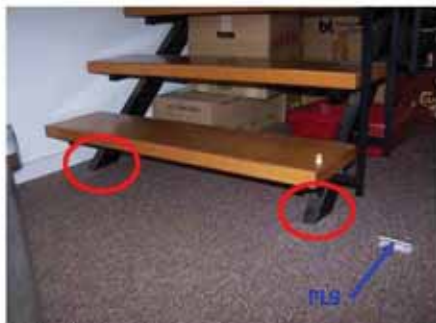
#35 Test 7: Indtrængning af sporgas i punkter hvor trappens vanger er forankret i gulvet (rødt niveau).
