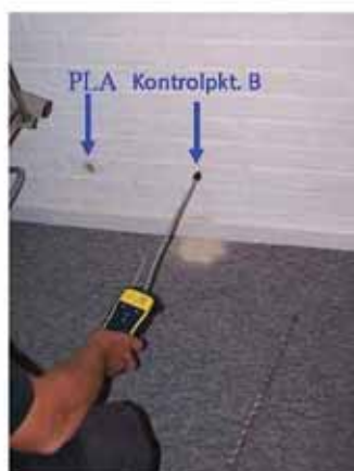
#5 Test 3: Poreluftpunkt PLA og kontrolpunkt B i hulmur mod trappeopgangen. Pkt. B er benyttet til udledning i Test 8.
