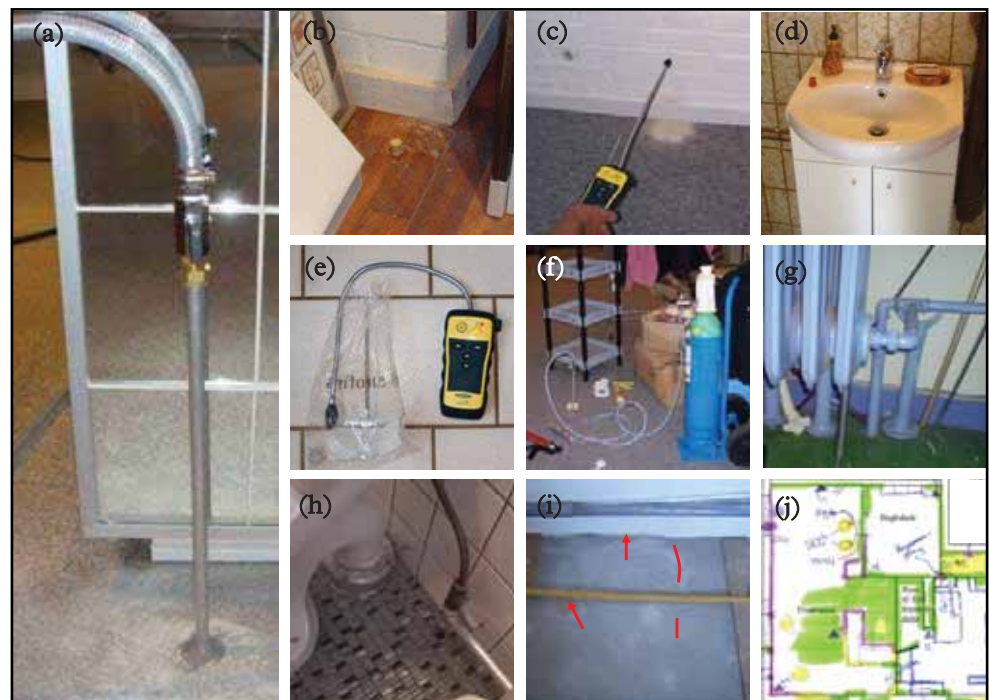
Figur 2.3: Eksempler på etablering af injektionspunkt og kontrolpunkter, samt baggrundscheck, sporgasinjektion, afsøgning af potentielle indtrængningspunkter og feltlog.
