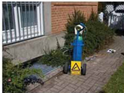
#8 Test 7: Udlledning af sporgas i ventilationsdræn S1 og S2.
