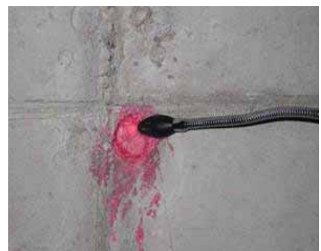
Figur 3.15: Detektoren reagerer på afgasning fra PU-skum.
