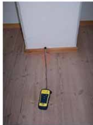
#12: Fra sporgasforsøg: Detektion i skorsten.
