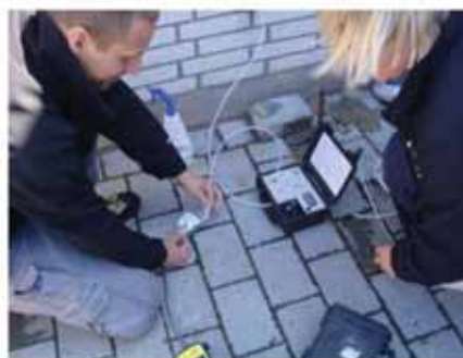
#16 Målesystem med Ripo-pumpe, jordpo-se og detektor til måling på Mur1 – Mur3 og PL101 – PL103.
