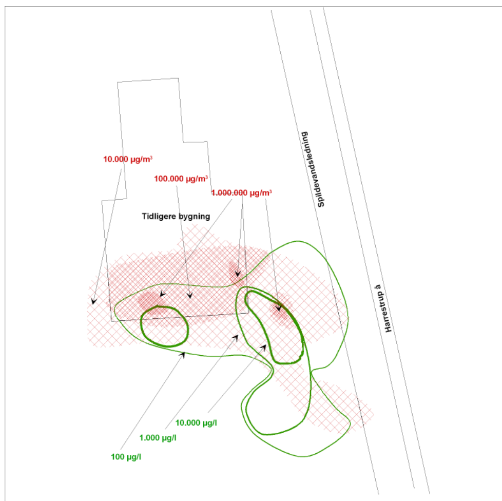
Figur 4.1 Konceptuel model, horisontal t plan. Forureningsudbredelse i hhv. grundvand og poreluft.
