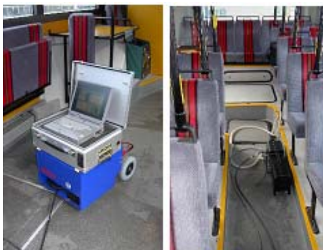
Figur 5 Mobil t udstyr til måling på landevej. På billedet til venstre ses femgasmåler med batteriboks og computer, og til højre ses opacitetsmåleren med slanger, som er ledt ned gennem bundpladen i bussen og ud til udstødningens afgangsstuds.
