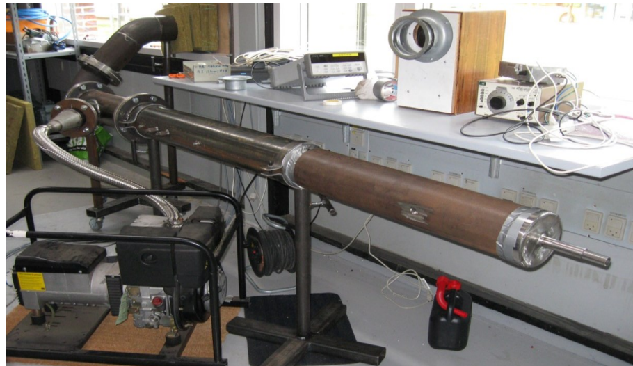
Figur 15 Forsøgsopstilling med motorudstødsystem i stålør.
