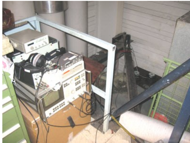
Figur 33 Målesystem opstillet inde i motorhal nær højttalere monteret på mandehullet.
