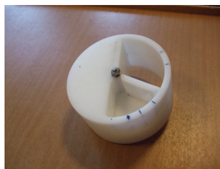
Figur 23 Skitse og foto af drejespjældmodellen udskåret i hård plast.
