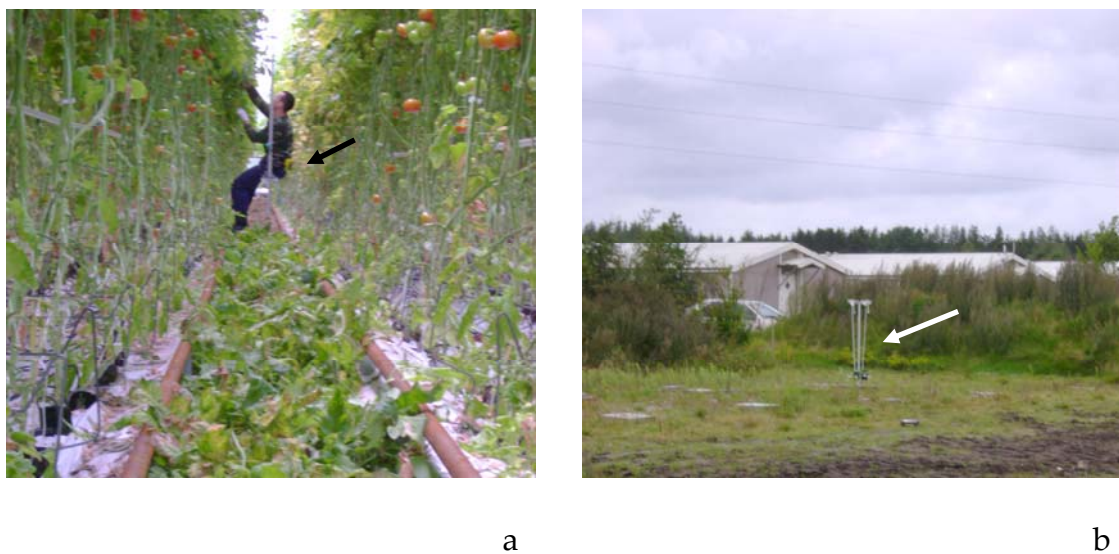
Figur 1. Ansatte bar udstyr til opsamling af luftbærent støv og mikroorganismer. 117 gange bar medarbejdere udstyret igennem en arbejdsdag. Pilen peger på en pumpe, som anvendes til opsamling af støv (a). Stationært udstyr (ved pil) til opsamling af referencestøv blev placeret udendørs (b). Støvet blev senere analyseret i laboratoriet for indhold af mikroorganismer.
