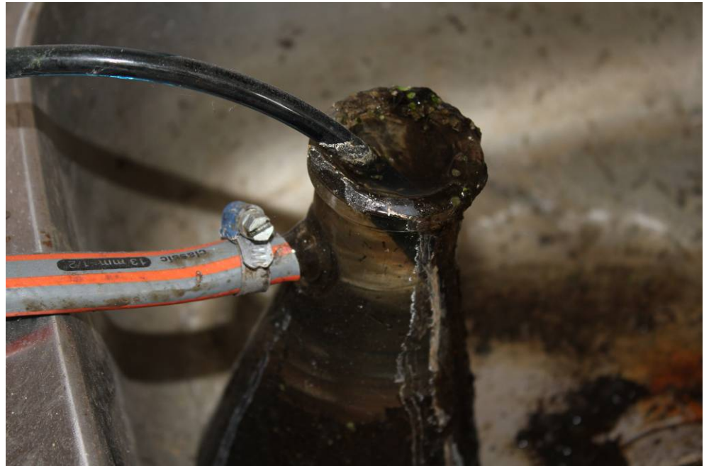
Figur 16 frostsprængt sugokolbe til analysator
