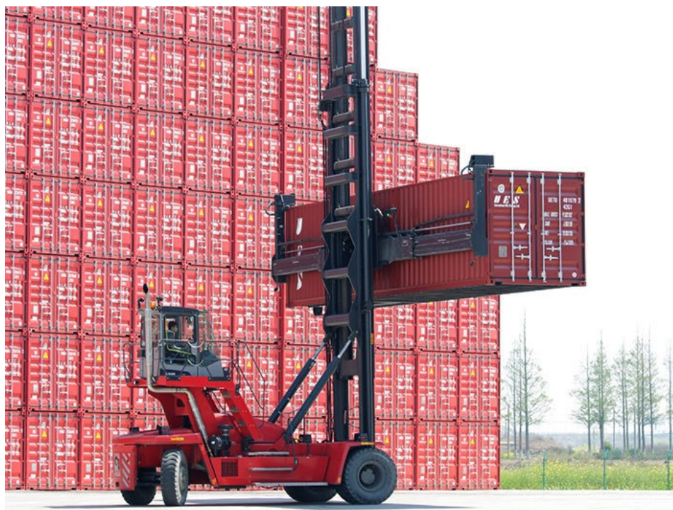
Figur 2.7: Eksempel på Empty Stackers, der anvendes til flytning og stakning af tomme containere.
